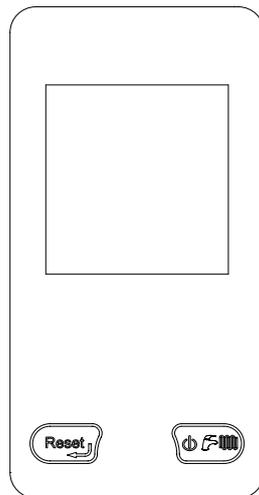
1- Per modificare il parametro **P00** bisogna premere contemporaneamente i tasti "reset" e "stato di funzionamento" per tre secondi.
