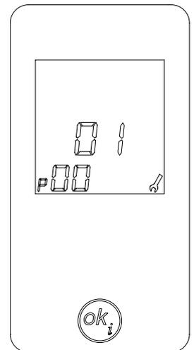
3 - Il valore del parametro può essere modificato con i tasti "+ e - riscaldamento". Se si decide di uscire schiacciando il tasto "reset", il parametro mantiene il precedente valore. Per confermare la modifica del valore bisogna toccare il tasto "ok".
