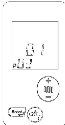
2- Con i tasti "+ e - riscaldamento" si scorrono i parametri. Una volta arrivati a quello desiderato per modificarlo bisogna premere il tasto "ok". La chiave inglese si accende ed indica che è possibile modificare il valore del parametro.
