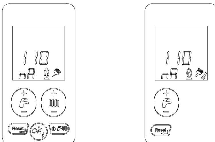
Azionando i tasti “+/- sanitario” (A, fig. 1) è possibile modificare la corrente fornita al modulatore della valvola gas da un valore minimo (parametro P96) ad un valore massimo (parametro P95) impostati in automatico in base al tipo di caldaia.
