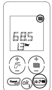
6. Per regolare la temperatura dell'acqua calda sanitaria premere i tasti + e - dell'acqua calda sanitaria (A in fig. 1). Regolare la temperatura in base ai propri utilizzi.
