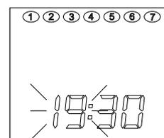
2. Con i tasti +/- **RISCALDAMENTO** è possibile modificare i valori che lampeggiano. Il primo valore da modificare sono le "ORE".
