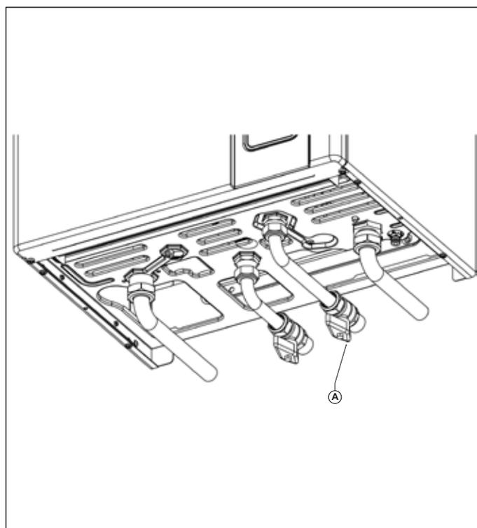
Fig. 3 Rubinetto di carico modello RTFS
