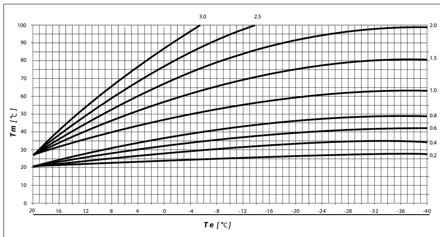
Fig. 15 Curve di termoregolazione
