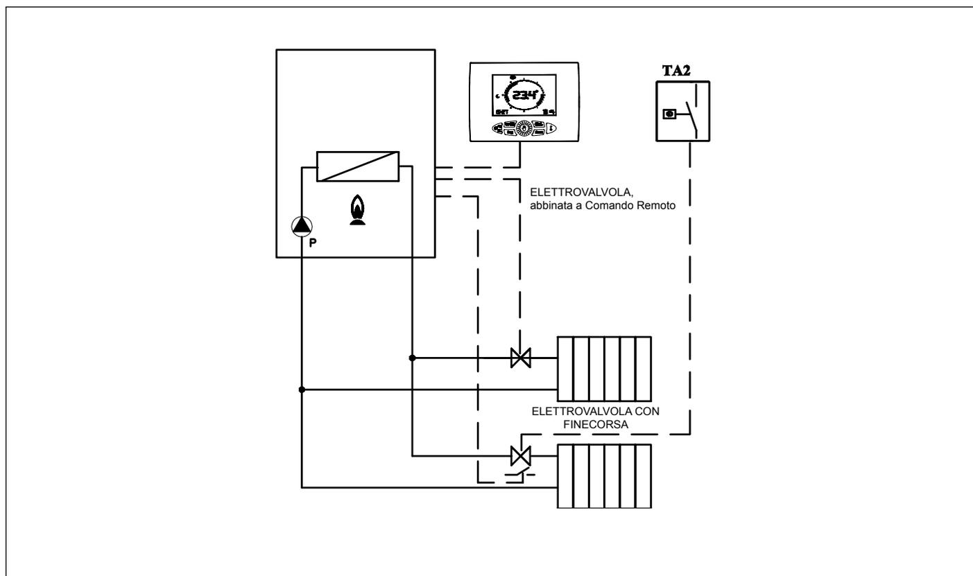
Fig. 27 Relè con comando remoto e TA2
