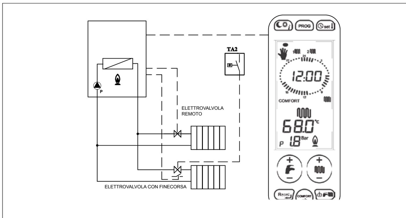
Fig. 28 Relè con programmazione interfaccia e TA2
