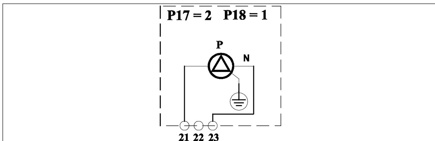
Fig. 20 Schema di collegamento relè multifunzione
