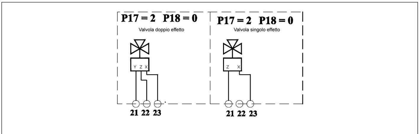
Fig. 26 Schema di collegamento relè multifunzione (X= neutro; Y= in caldaia; Z= al collettore)
