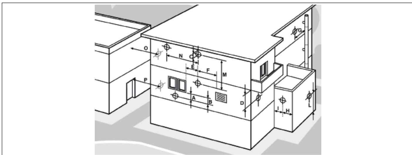
Fig. 8 Posizionamento dei terminali per apparecchi a "tiraggio forzato"
