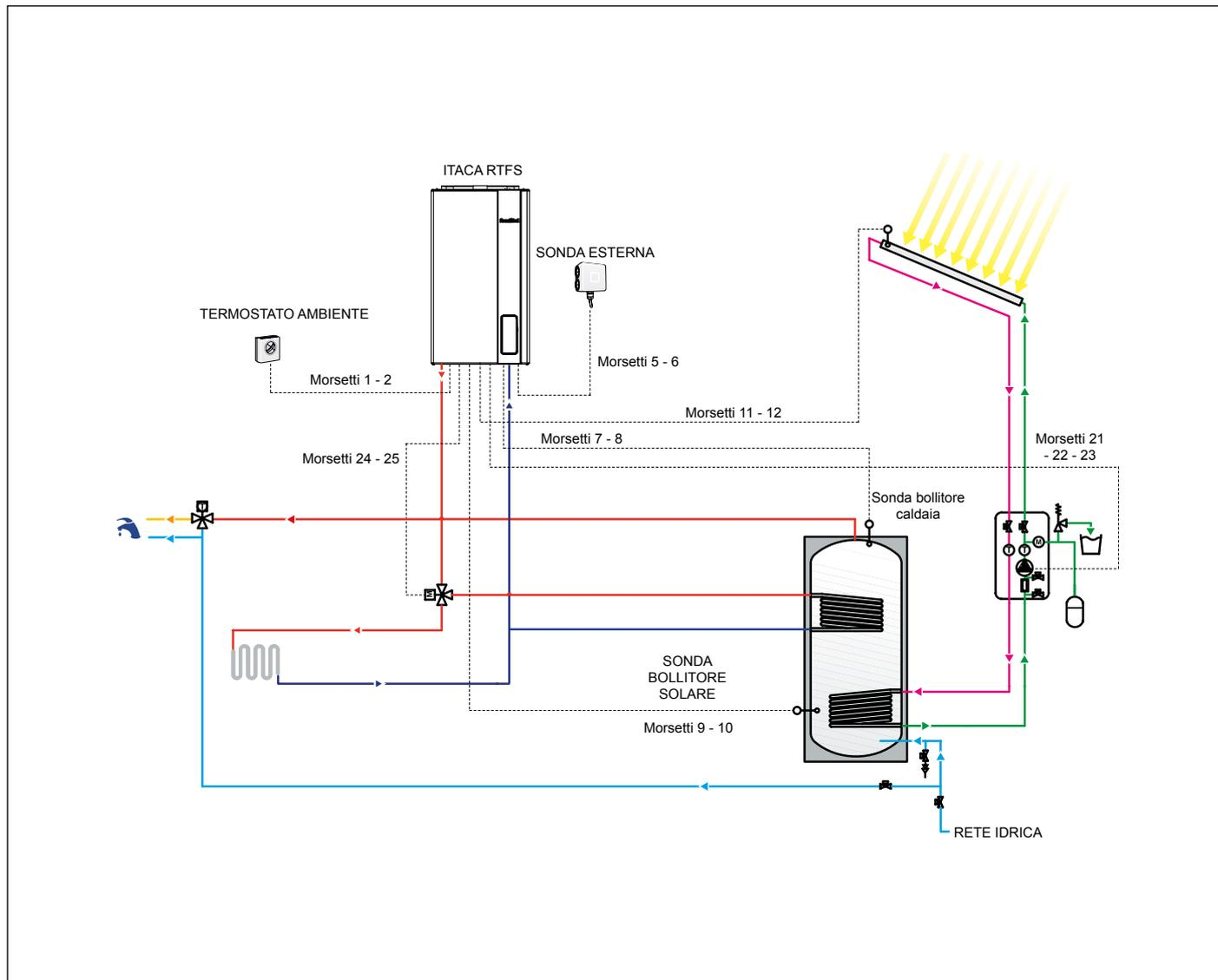
Fig. 19 Schema di collegamento impianto solare a circolazione forzata con caldaia solo riscaldamento
