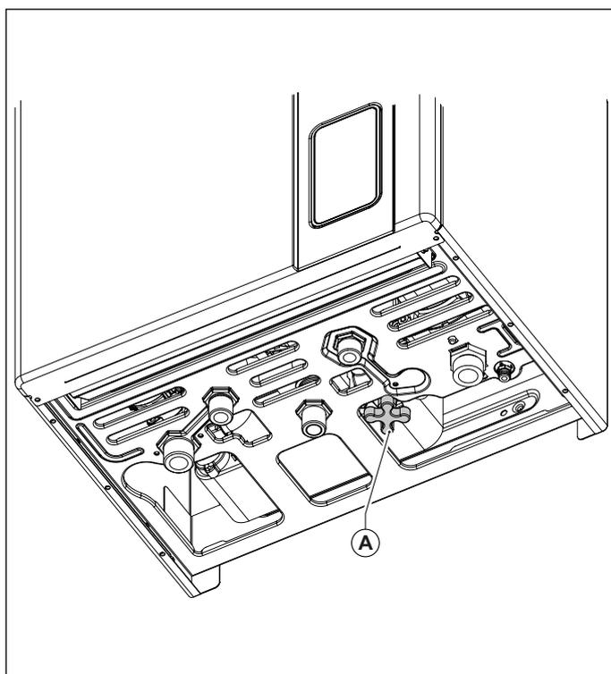
Fig. 2 Rubinetto di carico modello CTFS
