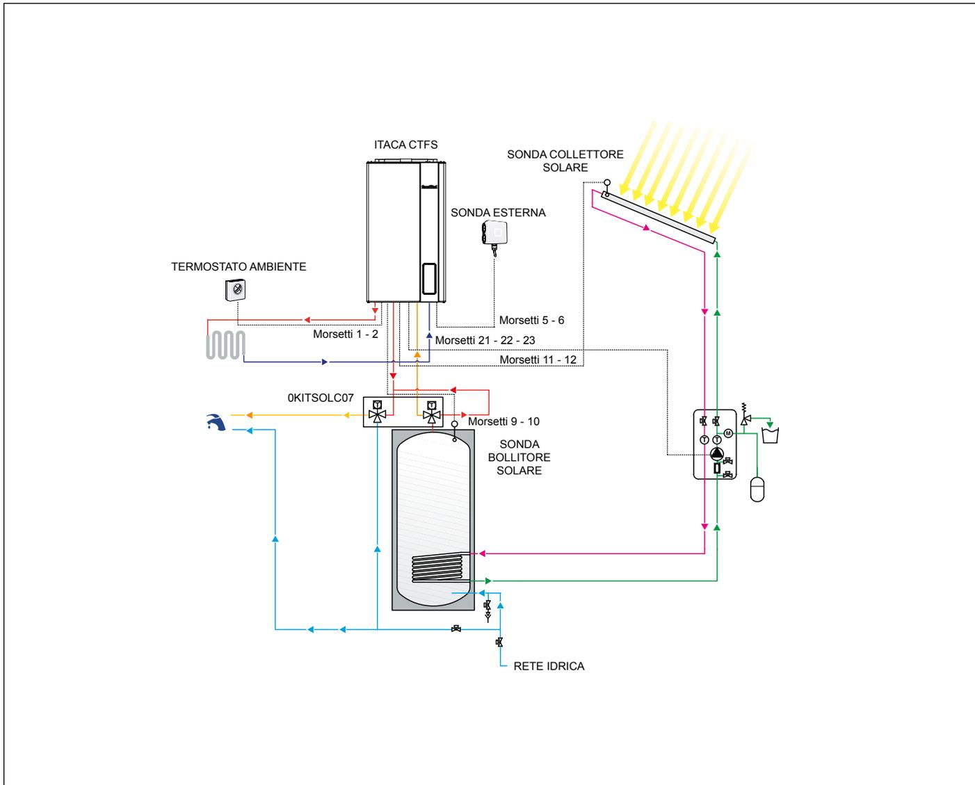
Fig. 23 Schema di collegamento impianto solare a circolazione forzata con caldaia combinata
