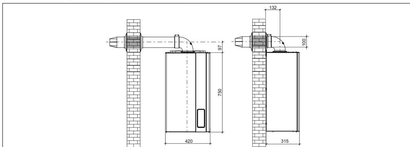
Fig. 11 Quote dimensionali per il collegamento al condotto di aspirazione aria/scarico dei fumi coassiale
