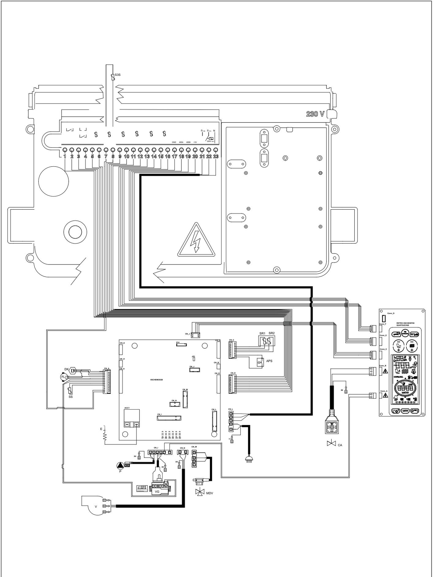
Fig. 21 Schema elettrico ITACA CTFS
