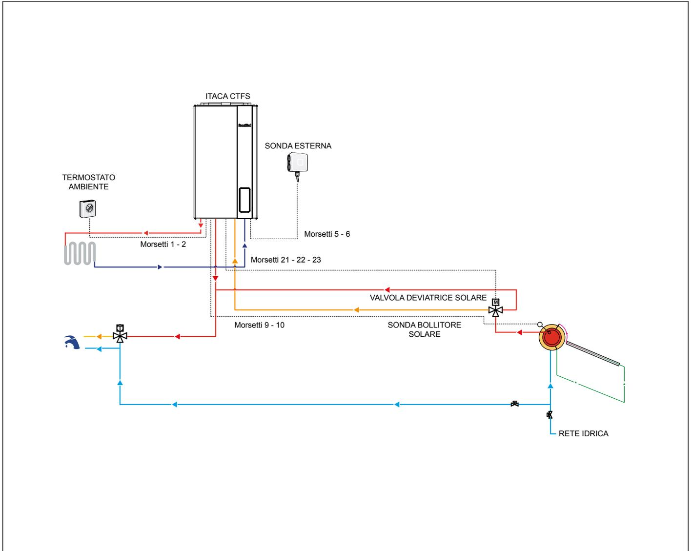
Fig. 25 Schema di collegamento impianto solare a circolazione naturale con caldaia combinata
