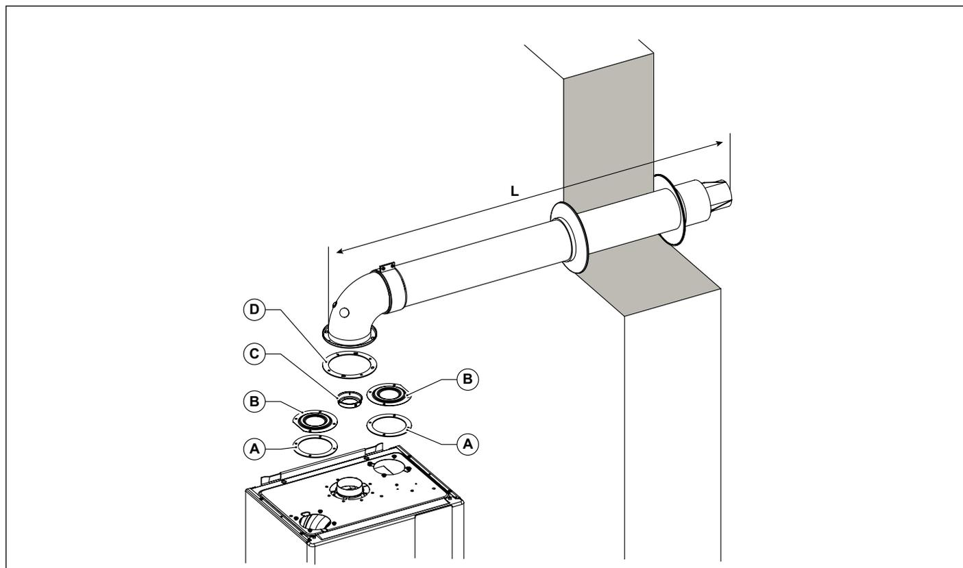
Fig. 10 Aspirazione aria e scarico fumi a condotti coassiali
