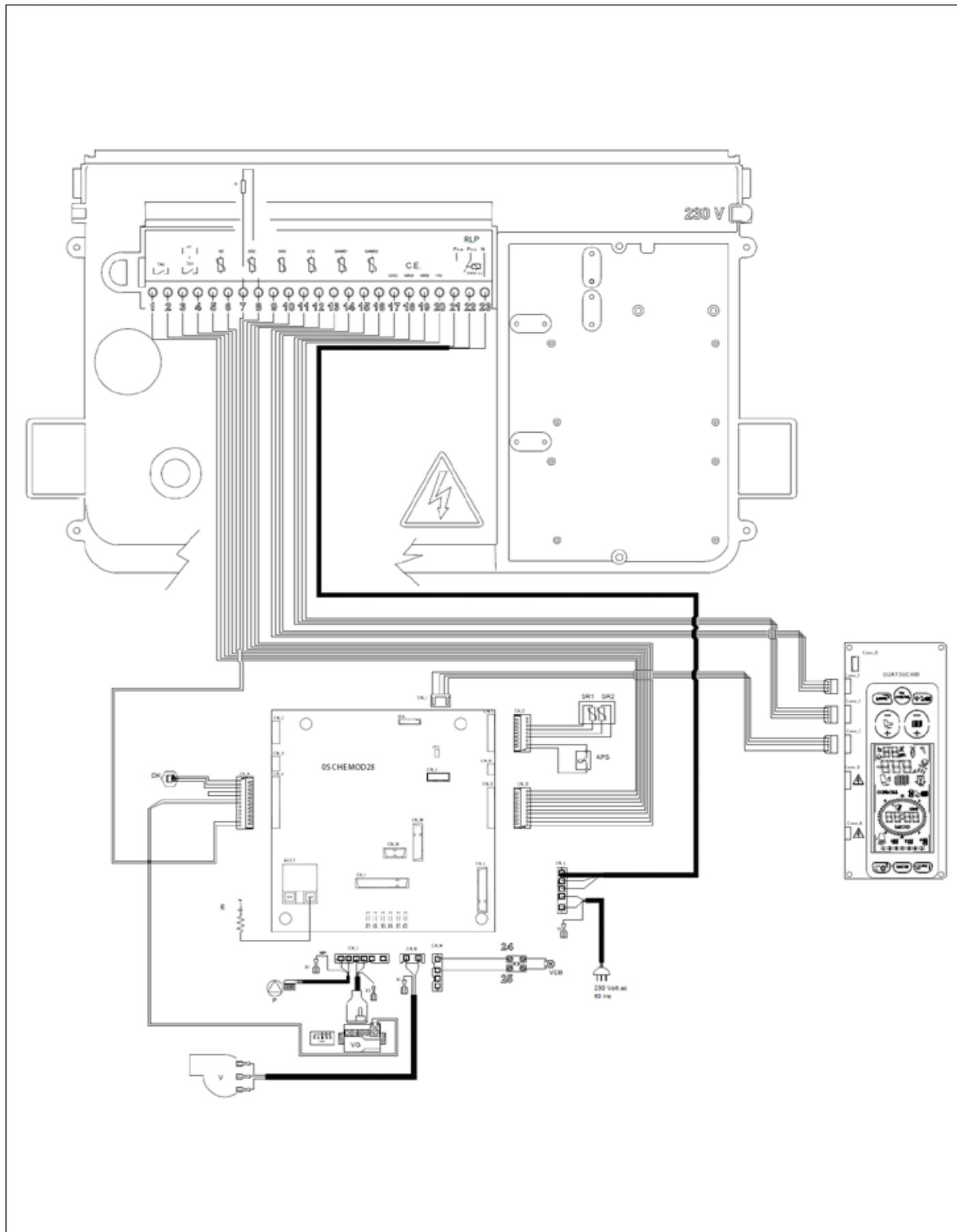
Fig. 17 Schema elettrico RTFS
