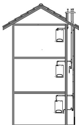
Installazione multipla con aspirazione a parete e condotti di scarico inseriti in asola tecnica
