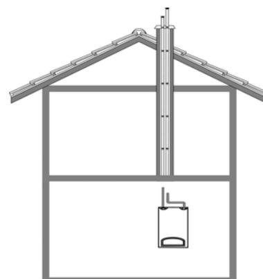
Aspirazione e scarico oltre la copertura in un'asola tecnica.
