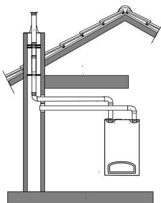
Installazione con aspirazione in asola tecnica e condotto di scarico ivi inserito
