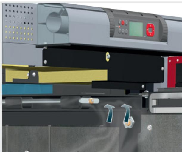
**Caratteristica: Particolare aspirazione dei gas sopra la porta di carico**
