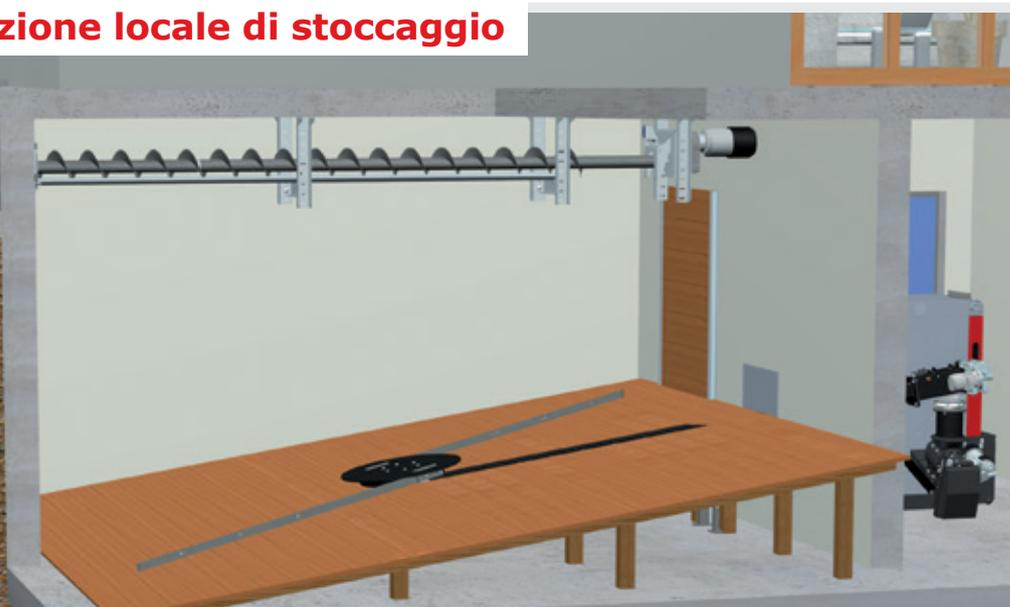
Il combustibile viene trasportato al deposito tramite la coclea di alimentazione locale di stoccaggio attraverso lo scivolo di scarico posizionato all'esterno del deposito. La coclea di alimentazione locale stoccaggio si arresta automaticamente quando il deposito è pieno. Il pavimento inclinato raffigurato non è strettamente necessario per un perfetto funzionamento del sistema d'estrazione.
