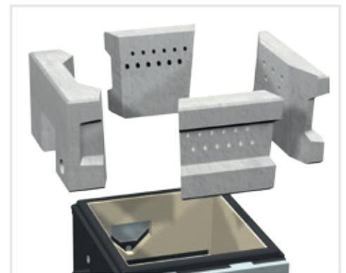
La forma brevettata dei mattoni della storta rende particolarmente stagna la conduzione dell'aria nella camera di combustione senza dover utilizzare costose guarnizioni soggette a usura. Inoltre la nuova forma dei mattoni della storta aumenta la facilità di manutenzione della camera di combustione poiché i mattoni si possono rimuovere agevolmente.
