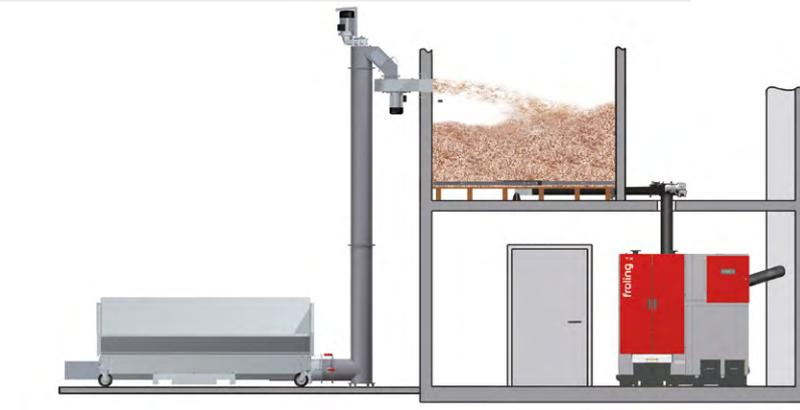
Il deposito si trova sopra il livello del locale caldaia. Il caricamento di combustibile alla caldaia viene realizzato mediante un tubo di caduta. Qui si consiglia di utilizzare una valvola a stella. Il deposito può essere riempito comodamente con l'estrattore a coclea verticale o tramite immissione del combustibile.
