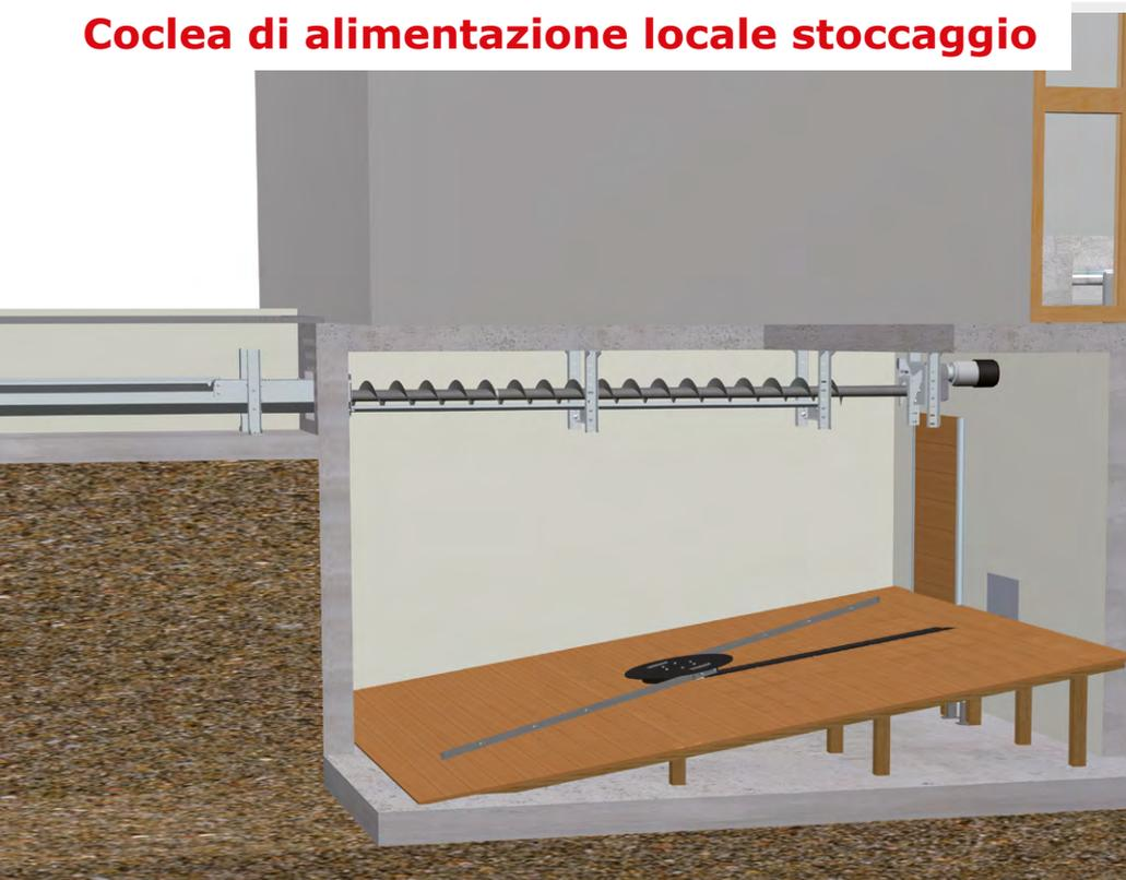
La coclea di alimentazione locale stoccaggio trasporta il combustibile al deposito in modo affidabile e si arresta automaticamente quando il deposito è pieno.
