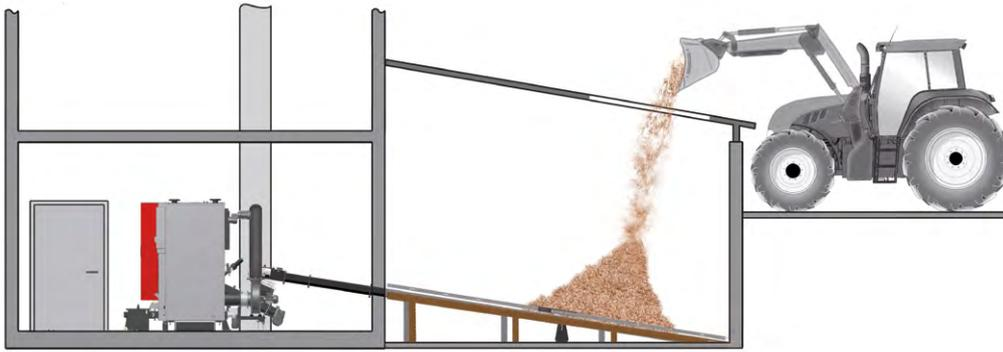
Il deposito, collocato a livello del suolo rispetto al locale caldaia, può essere realizzato perlopiù tramite un ampliamento economico.
