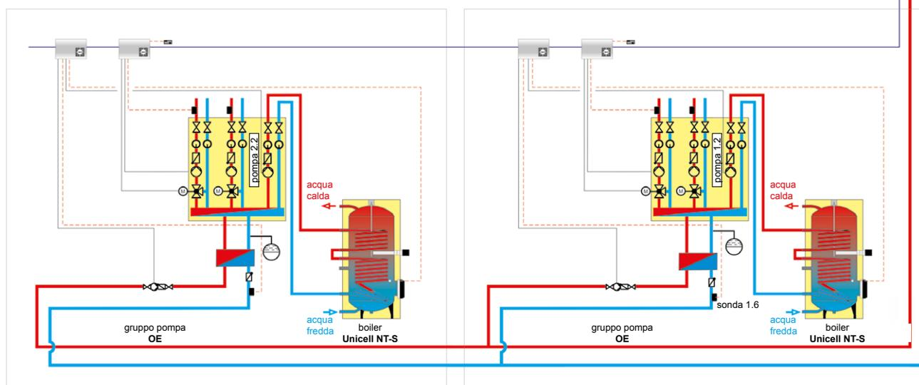
Sistema pluriresidenziale TX con accumulatore a stratificazione e Unicell NT-S
