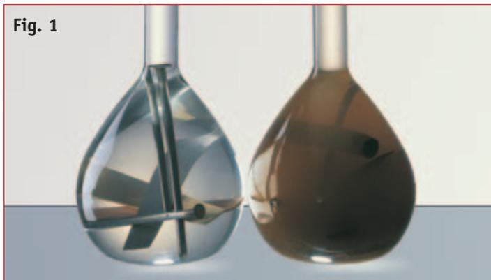
**Primo livello.** Inibisce la corrosione e non consente formazione di ruggine. (Fig. 1)
