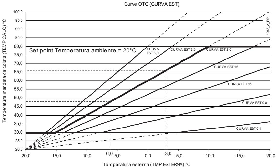
Più il clima della zona è rigido (ad esempio paesi nordici o alta montagna), più elevato dovrà essere il valore di questo parametro: la curva scelta sarà più ripida e la temperatura di mandata aumenterà più velocemente al diminuire della temperatura esterna. All'estremo opposto, il valore 0.0 del parametro *CURVA EST*, per il quale la curva nel grafico coincide con l'asse orizzontale, renderà di fatto ininfluente la temperatura esterna.
