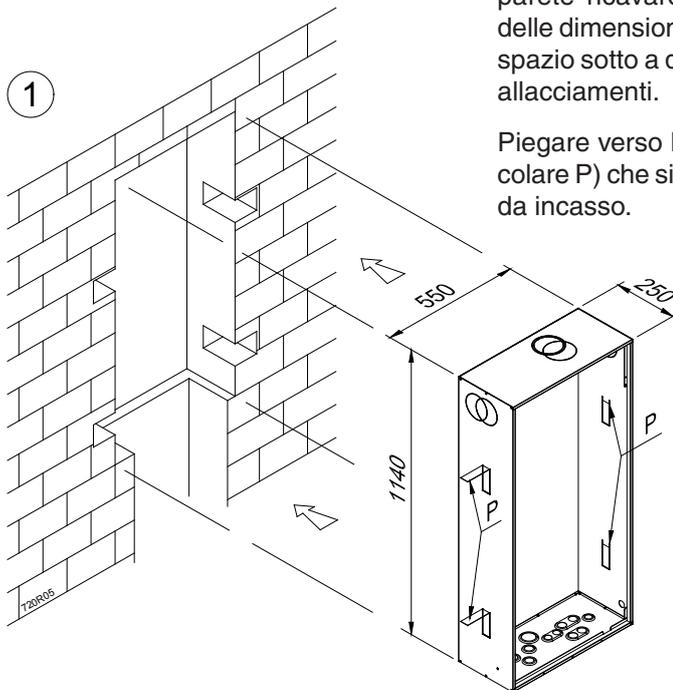
**Fig.1** - A seconda della profondità della parete ricavare un nicchia o un'apertura delle dimensioni dell'unità da incasso e uno spazio sotto a questa per poter eseguire gli allacciamenti.
