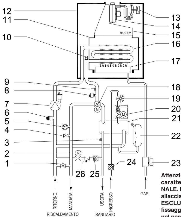
**Attenzione: questo schema ha carattere solamente FUNZIONALE. Per la realizzazione degli allacciamenti idraulici utilizzare ESCLUSIVAMENTE la ditta di fissaggio o il disegno contenuto nel paragrafo "Installazione".**
