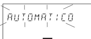
🔗 In seguito è visualizzato in forma lampeggiante sul display il modo esercizio attualmente attivo.
