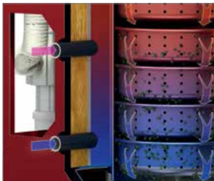
I ritorni separati per alta e bassa temperatura aumentano l'efficienza della tecnica di condensazione.
