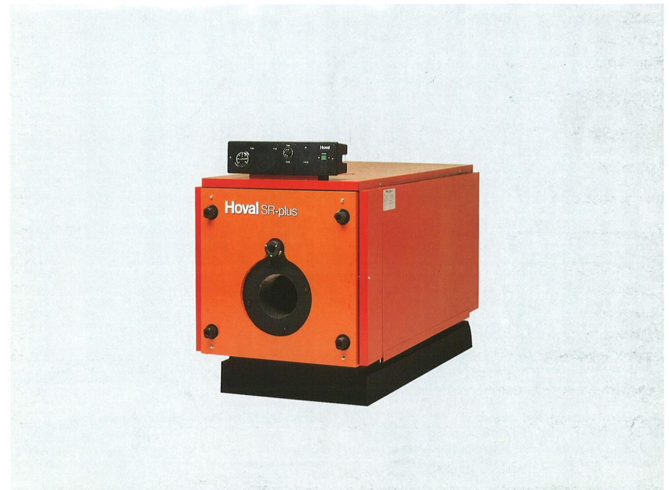
Caldaia pressurizzata in acciaio ad alto rendimento per gas, gasolio e olio combustibile. Portellone della caldaia ruotante a destra.
