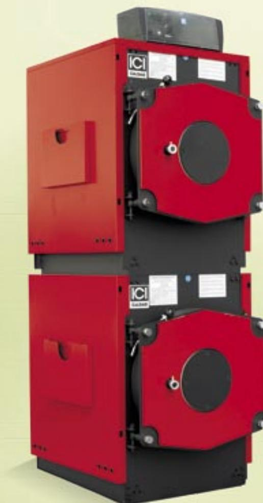
Su richiesta è disponibile un collettore fumi che convoglia in un unico condotto gli scarichi dei due moduli. L'elettronica di regolazione consente di gestire in sequenza 2 generatori modulari STELT DUAL al fine di raggiungere una potenzialità complessiva di 300 kW utili.
