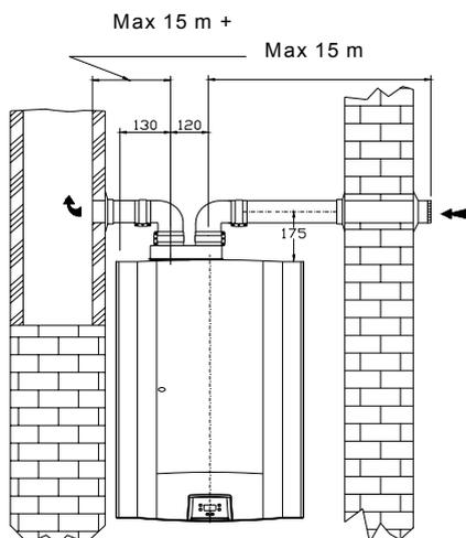
N.B.: La somma della lunghezza del tubo di scarico e quella del tubo di aspirazione non deve superare i 30 metri.
