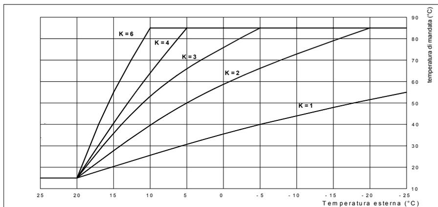
La regolazione della temperatura ambiente può avvenire utilizzando la sola compensazione della temperatura di mandata con la temperatura esterna o in combinazione con il remoto (vedasi descrizione relativa). La correzione della temperatura in di mandata viene effettuata con cadenza un minuto con una funzione di riduzione delle variazioni repentine.
