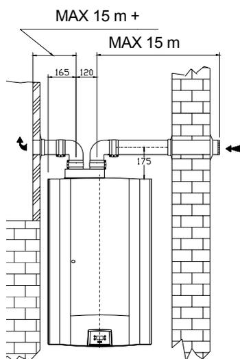
N.B.: La somma della lunghezza del tubo di scarico e quella del tubo di aspirazione non deve superare i 16 metri.
