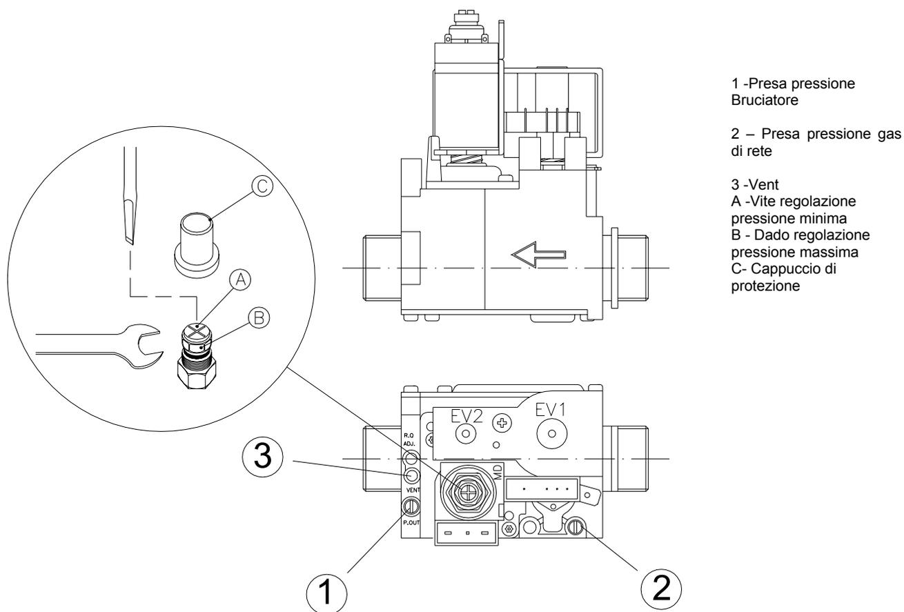
**Per eseguire il controllo delle pressioni al bruciatore, inserire le sonde del manometro nelle prese di pressione disponibili sulla valvola gas (vedi fig.).**
