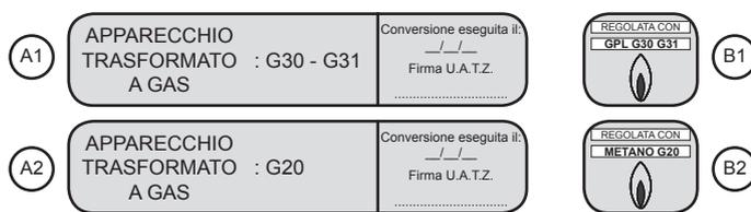
3- In funzione del nuovo tipo di gas utilizzato, applicare l'etichetta (A1) o (A2) (figura 67), presenti modulo cambio gas a corredo del gruppo termico, nella parte sottostante della targhetta dati, facendo attenzione a coprire solamente la parte con l'indicazione della predisposizione del tipo di gas (figura 69);
