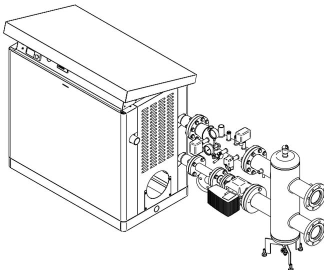
Kit copertura da esterno per kit INAIL con scambiatore a piastre.
