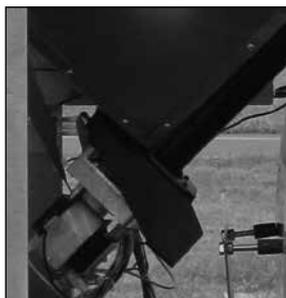
Motoriduttore: se il motoriduttore si guasta nella fase di lavoro compare la segnalazione **"ALAR-NO-FIRE"** e la caldaia continua a funzionare fino a quando non si spegne la fiamma per mancanza di combustibile e fino a che non raggiunge il livello minimo di raffreddamento.
