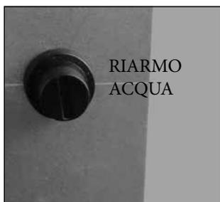
Termostato di sicurezza a riarmo manuale per la temperatura dell'acqua: se la temperatura dell'acqua supera il valore di sicurezza impostato a 100 °C, si arresta immediatamente il funzionamento della caldaia e sul display apparirà la scritta **"ALAR-SIC-FAIL"**.
