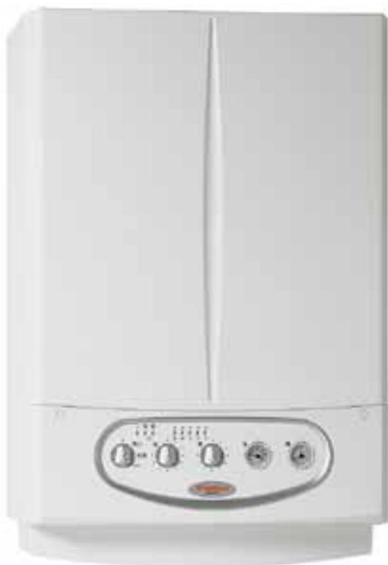
Caldia pensile compatta a camera aperta e tiraggio naturale per installazioni all'interno con bollitore in acciaio inox da 45 litri e potenza termica nominale di 23,7 kW (20.382 kcal/h). AVIO kW rispetta il valore di rendimento termico utile (al 30% del carico) previsto dal D. Lgs. 192/05 e s.m.i. (D.Lgs 311/06, D.P.R. 59/09), per l'allacciamento a canne fumarie collettive ramificate (c.c.r.).
