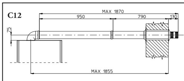
Collegamento con N°1 prolunga. Distanza fra asse verticale caldaia e parete esterna mm 1855.
