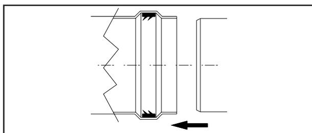
**Installazione diaframma.** Per un corretto funzionamento della caldaia è necessario installare sull'uscita della camera stagna e prima del condotto di aspirazione e scarico un diaframma (vedi figura). La scelta del diaframma appropriato avviene in base al tipo di condotto e alla sua massima estensione: detto calcolo si può effettuare con l'utilizzo delle seguenti tabelle:
