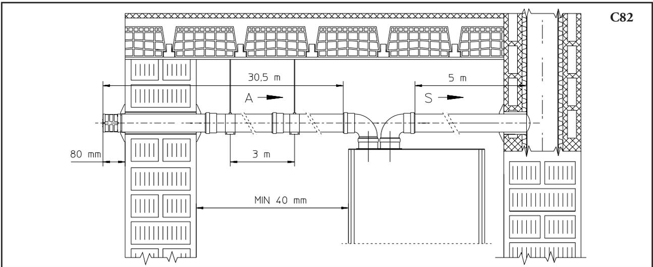
**N.B.:** Durante l'installazione dei condotti Ø 80 è necessario installare ogni 3 metri una fascetta rompitratta con tassello.
