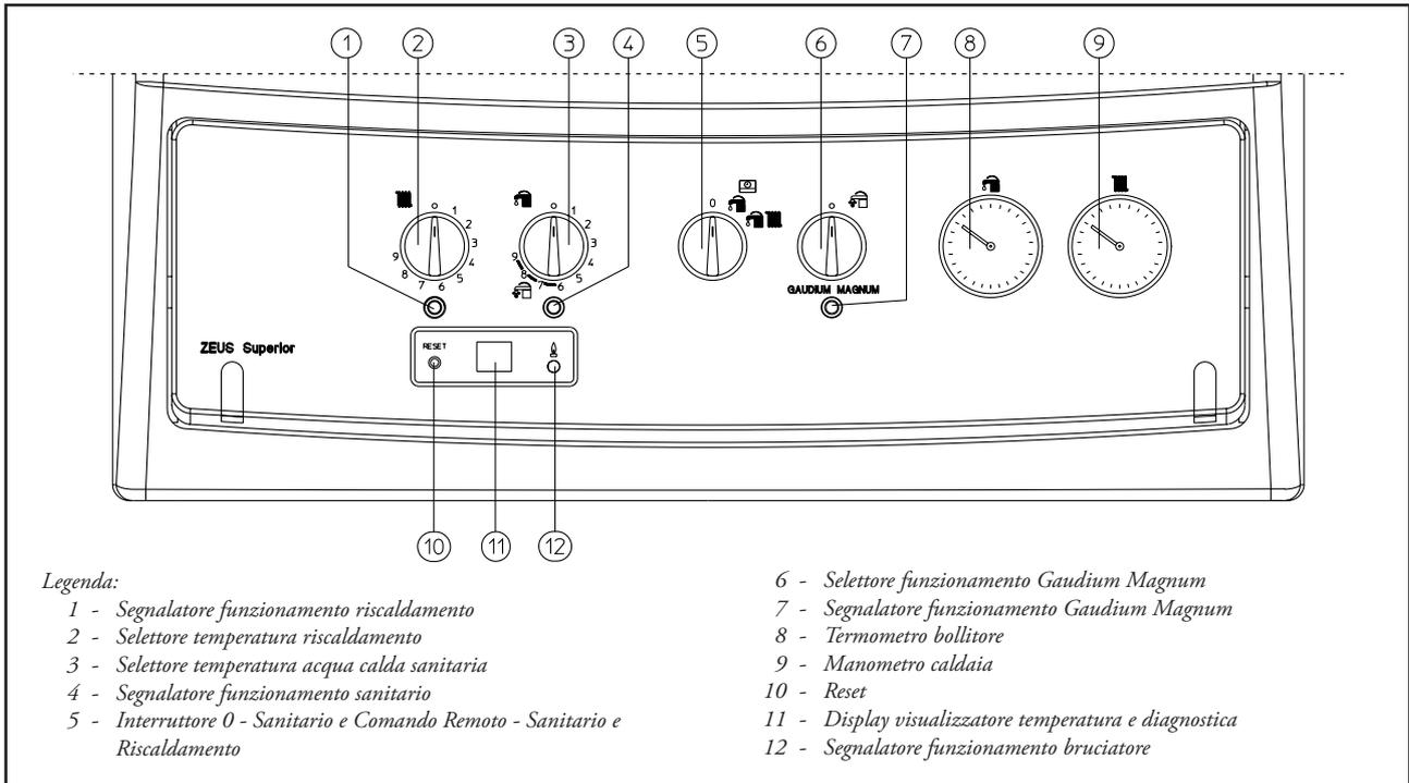
**Accensione della caldaia.** Prima dell'accensione verificare che l'impianto sia pieno d'acqua controllando che la lancetta del manometro (9) indichi un valore compreso fra  $1 \div 1,2$  bar.
