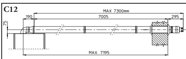
**N.B.:** durante l'installazione dei condotti è necessario installare ogni 3 metri una fascetta rompitratta con tassello.
