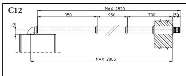
Collegamento con N°2 prolunghe. Distanza fra asse verticale caldaia e parete esterna mm 2805.
