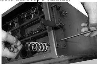
Ora la sezione superiore allo scambiatore di calore è sgombra da qualsiasi ingombro in modo da permettere una perfetta pulizia. Una volta all'anno è consigliato ripulire anche il vano superiore allo scambiatore. Per effettuare una corretta pulizia si consiglia di aspirare la cenere, togliere tutte le giunzioni orizzontali con un cacciavite, quindi di nuovo aspirare la cenere.
