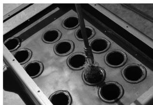
È possibile effettuare la pulizia dopo aver tolto le molle inserite in ogni tubazione. L'operazione è semplice sfilando le molle dal perno orizzontale a cui sono fissate.
