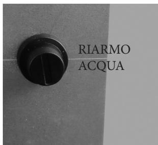
**Termostato di sicurezza a riarmo manuale per la temperatura dell'acqua:** se la temperatura dell'acqua supera il valore di sicurezza impostato a 100 °C si arresta immediatamente il funzionamento della caldaia e sul display apparirà la scritta **"ALAR-NO-FIAM"**. Per riavviarla è necessario ripristinare il termostato manualmente.
