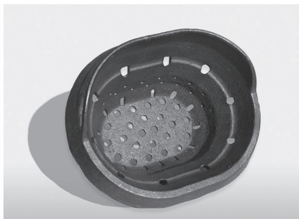
Ricordarsi che solo un braciere posizionato e pulito correttamente può garantire un'accensione e un funzionamento ottimale della vostra caldaia a pellet. Nel posizionare il crogiuolo, verificare accuratamente che i bordi dello stesso aderiscano completamente alla loro sede e che il foro coincida con il tubo dedicato al passaggio della resistenza.
