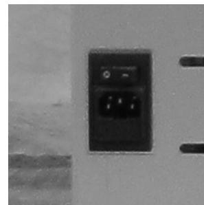
**Sicurezza elettrica:** la caldaia è protetta contro gli sbalzi violenti di corrente (es. fulmini) da un fusibile generale a 4 A che si trova nel pannello comandi posto sul retro della caldaia vicino al cavo di alimentazione. Altri fusibili per la protezione delle schede elettroniche sono situati su quest'ultime.
