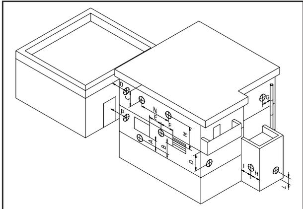
**Scarico dei prodotti della combustione di apparecchi a tiraggio forzato entro spazi chiusi a cielo libero.** Negli spazi a cielo libero chiusi su tutti i lati (pozzi di ventilazione, cavei, cortili e simili), è consentito lo scarico diretto dei prodotti della combustione di apparecchi a gas a tiraggio naturale o forzato e portata termica oltre 4 e fino a 35 kW, purché vengano rispettate le condizioni di cui alla normativa tecnica vigente (UNI 7129:2001 par. 5.7).
