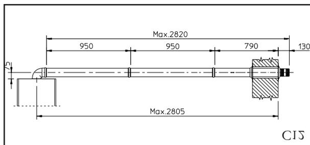
Collegamento con N°2 prolunghe. Distanza massima fra asse verticale caldaia e parete esterna mm 2805.
