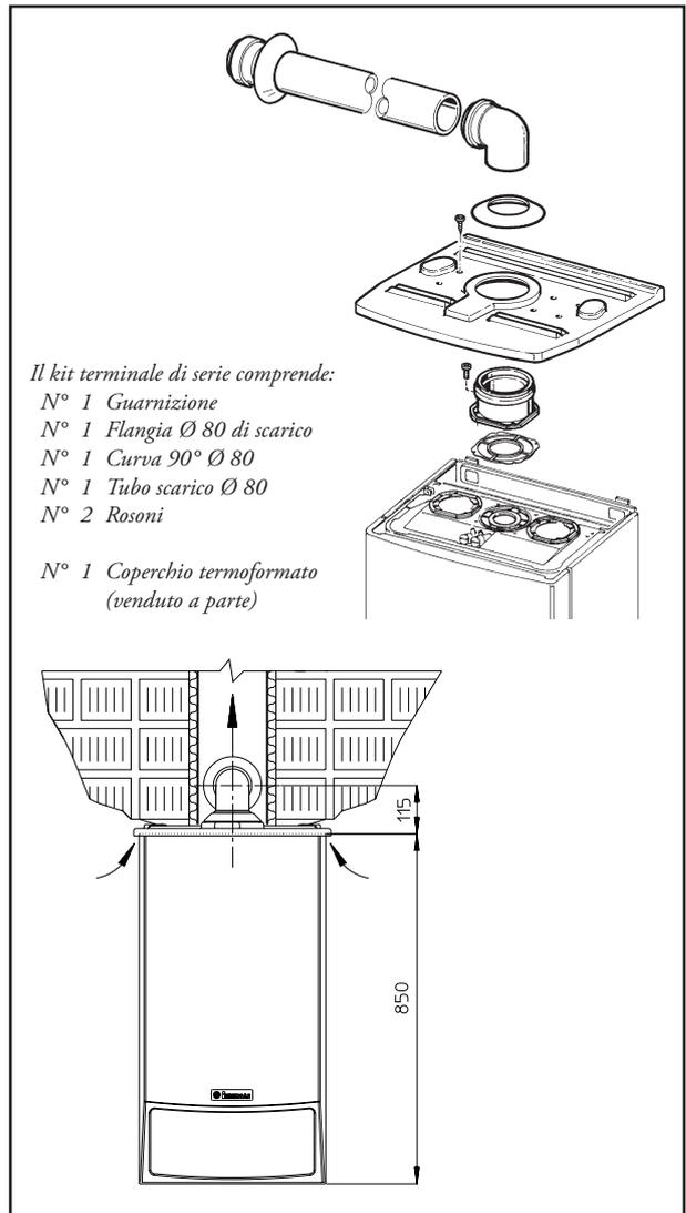
**Esempio di installazione con terminale verticale.**
