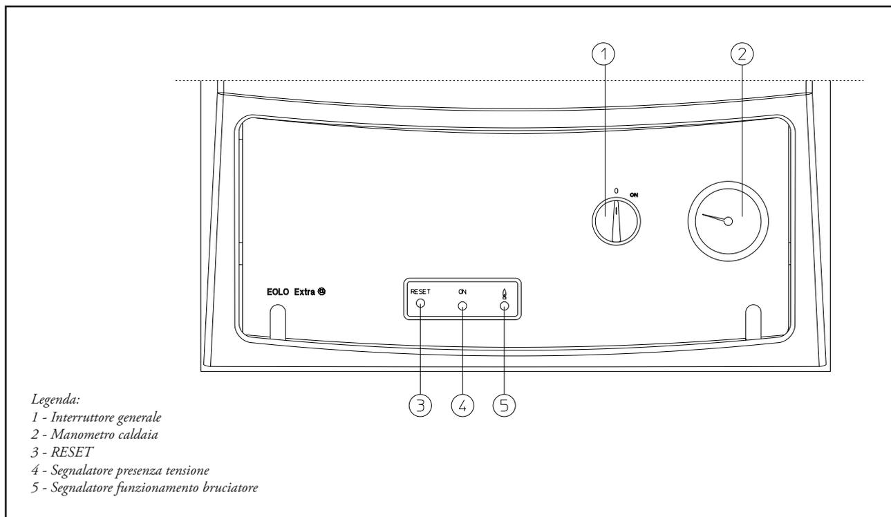
**Accensione della caldaia.** Prima dell'accensione verificare che l'impianto sia pieno d'acqua controllando che la lancetta del manometro (2) indichi un valore compreso fra 1÷1,2 bar, che il Comando Amico Remoto sia collegato ed il suo selettore sia posto in posizione Estate o Inverno.
