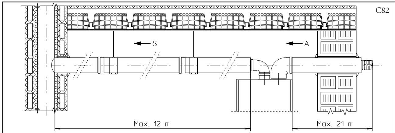
**Installazione all'interno in configurazione B<sub>22</sub>.** L'apparecchio può essere installato all'interno degli edifici in modalità B<sub>22</sub>; in tale eventualità, si raccomanda di ottemperare a tutte le norme tecniche, le regole tecniche e le regolamentazioni vigenti, nazionali e locali.
