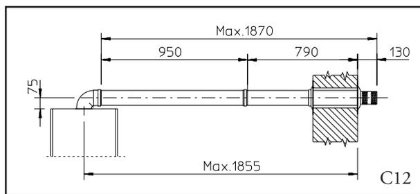
Collegamento con N°1 prolunga. Distanza massima fra asse verticale caldaia e parete esterna mm 1855.
