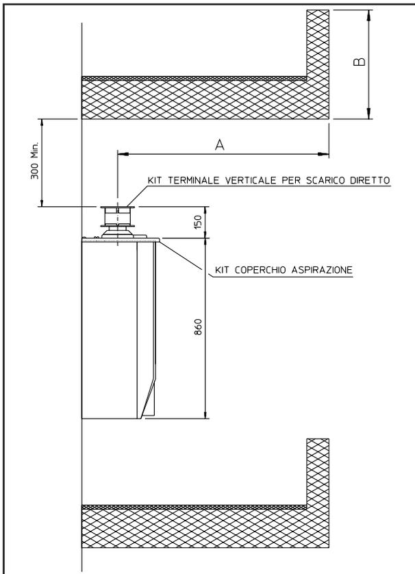
**Installazione diaframma.** Per un corretto funzionamento della caldaia è necessario installare sull'uscita della camera stagna e prima del condotto di aspirazione e scarico un diaframma Ø 46.
