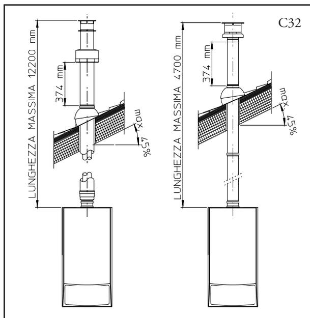
**Kit separatore Ø 80/80.** Il kit separatore Ø 80/80, consente di separare i condotti di scarico fumi e aspirazione aria secondo lo schema riportato in figura.
