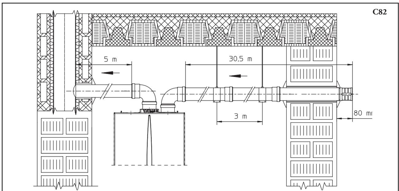
**N.B.:** Durante l'installazione dei condotti Ø 80 è necessario installare ogni 3 metri una fascetta rompitratta con tassello.
