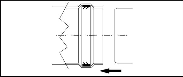
**Regolazione parzializzatore fumi.** Per un corretto funzionamento della caldaia è necessario regolare il parzializzatore fumi posto sul pozzetto di prelievo aria / fumi (vedi figura).
