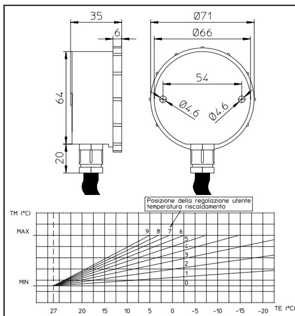
**Importante:** In caso di impianto suddiviso in zone il CAR deve essere utilizzato escludendo la sua funzione di termoregolazione climatica, ovvero impostandolo in modalità On/Off.
