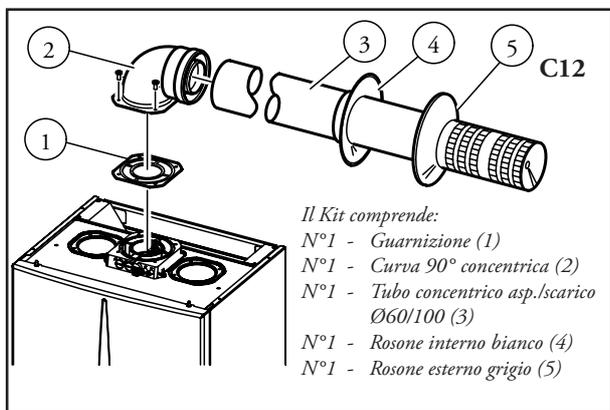
• Giunzione ad innesto di tubi o prolunghe e gomiti concentrici Ø60/100. Per installare eventuali prolunghe ad innesto con gli altri elementi della fumisteria, occorre operare come segue: innestare il tubo concentrico o il gomito concentrico con lato maschio (liscio) nel lato femmina (con guarnizioni a labbro) dell'elemento precedentemente installato sino a portarlo in battuta, in questo modo si otterrà la tenuta e la giunzione degli elementi correttamente.
