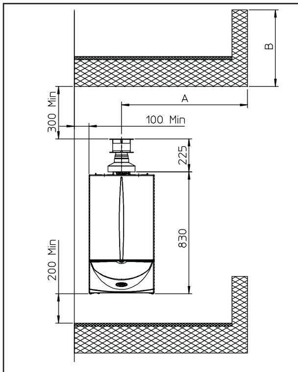
• **Configurazione senza kit aspirazione in luogo parzialmente protetto (caldaia tipo C).**
