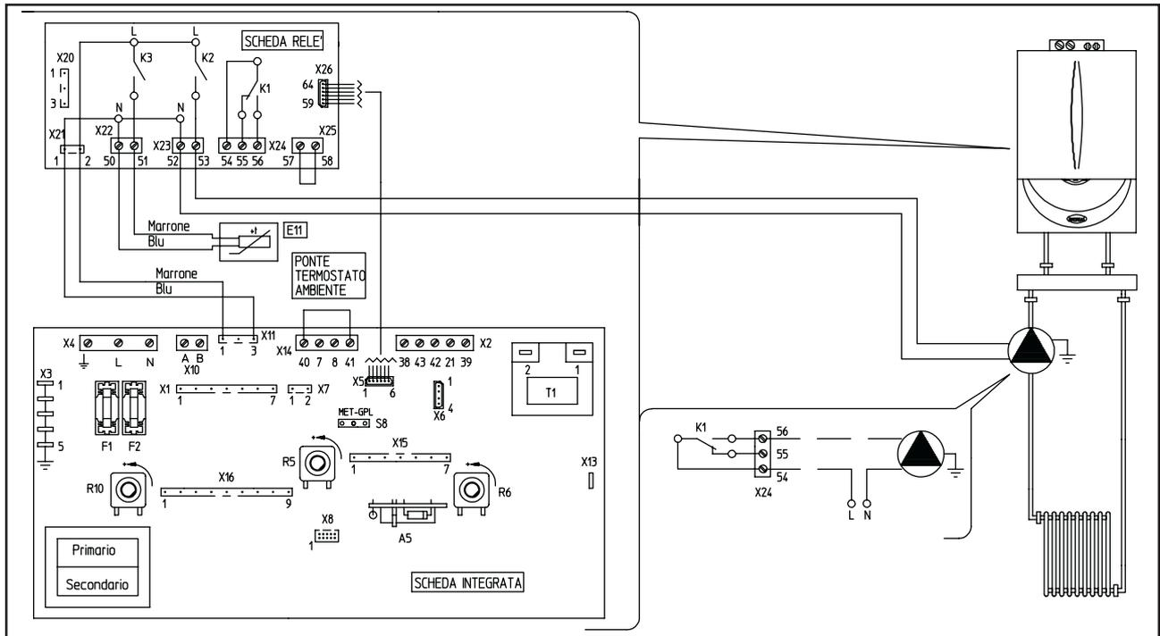
attiva, lo schema rappresenta la connessione sul relè 2. Nel caso di utilizzo di questo relè è necessario ponticellare i pin 57 e 58 del connettore X25 posto sulla scheda relè. Inoltre è rappresentato l'eventuale collegamento ai relè 1. Il relè 3 è collegato di serie al dispositivo Aqua Celeris.
