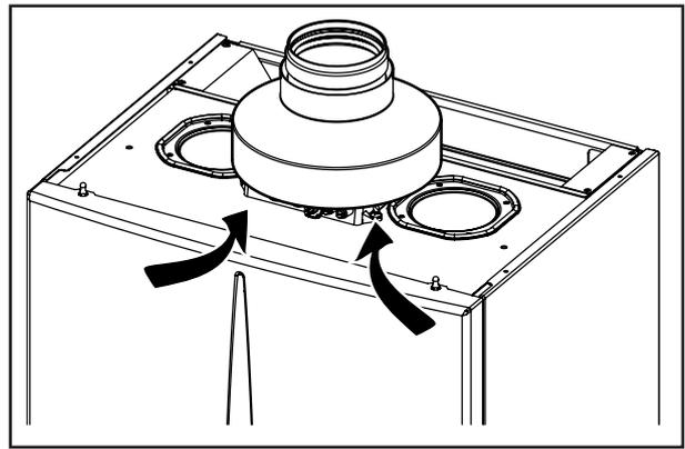
**Regolazione parzializzatore fumi.** Per un corretto funzionamento della caldaia in configurazione B<sub>22</sub> è necessario regolare il parzializzatore fumi spostando l'indicatore sulla tacca 5 (vedi pag. 9).
