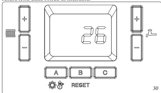
In caso di richiesta la caldaia si accende e vengono visualizzati i relativi simboli, con l'indicazione della temperatura letta dalla sonda di mandata.
