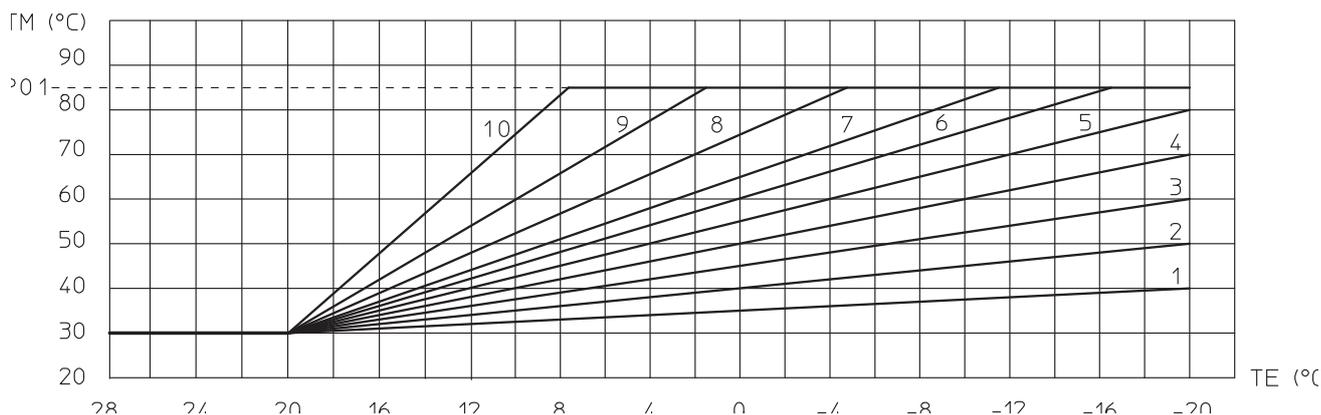
Nota: il presente grafico è realizzato con il valore di offset (P15) a 30 °C (valore di default), cambiando il valore di offset viene cambiata conseguentemente l'origine della curva della temperatura di mandata.
