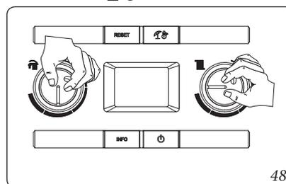
Una volta entrati in programmazione è possibile scorrere attraverso i cinque menù (G, P, t, A, F) premendo il pulsante "🚽" per 1 secondo.
