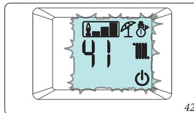
Solo dopo il lampeggio della cornice presenza fiamma (
