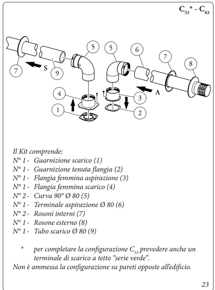
Innestare il terminale di aspirazione (6) con lato maschio (liscio), nel lato femmina della curva (5) sino a portarlo in battuta, accertandosi di avere già inserito i relativi rosconi interni ed esterni. Innestare il tubo di scarico (9) con lato maschio (liscio), nel lato femmina della curva (5) sino a portarlo in battuta, accertandosi di avere già inserito il relativo rosone interno, in questo modo si otterrà la tenuta e la giunzione degli elementi che compongono il kit.
