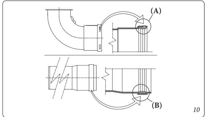
• **Posizionamento delle guarnizioni (di colore nero) per fumisteria "serie verde"**. Prestare attenzione ad interporre la guarnizione corretta (per curve o prolunghe) (Fig. 10):
