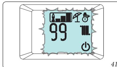
Solo dopo il lampeggio della cornice presenza fiamma ( ) è possibile correggere il valore della CO<sub>2</sub> (Parag. 3.12) oppure passare alla potenza successiva premendo il pulsante "INFO".
