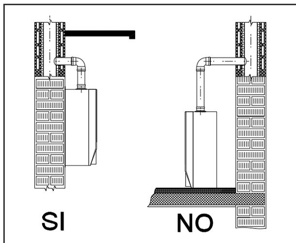
Questa caldaia è stata progettata unicamente per installazioni a parete; devono essere utilizzate per il riscaldamento ambienti e la produzione di acqua calda sanitaria per usi domestici e similari. La parete deve essere liscia, priva cioè di sporgenze o di rientranze tali da consentire l'accesso dalla parte posteriore. Non sono state assolutamente progettate per installazioni su basamenti o pavimenti (vedi figura).
