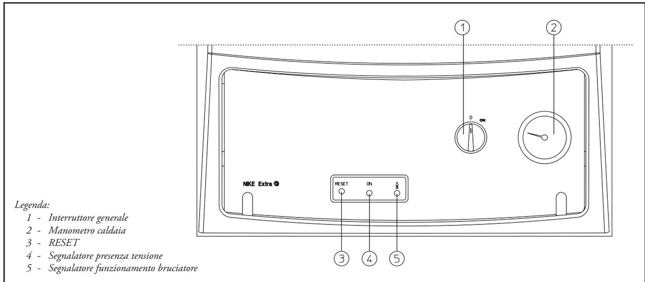
**Accensione della caldaia.** Prima dell'accensione verificare che l'impianto sia pieno d'acqua controllando che la lancetta del manometro (2) indichi un valore compreso fra 1÷1,2 bar, il Comando Amico Remoto sia collegato ed il suo selettore sia posto in posizione Estate o Inverno.
