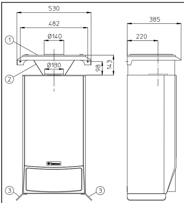
**Montaggio coperchio di protezione superiore:** Collegare il coperchio di protezione (1) e la squadretta sostegno coperchio (2) tra di loro in modo corretto tramite le viti in dotazione nel kit. Montare la squadretta con coperchio sul collare cappa fumi, quindi tracciare i fori per l'installazione a muro dello stesso (vedi figura). Togliere la squadretta con coperchio, forare il muro con una punta di diametro appropriato e rimontare il tutto sul collare cappa fumi avendo già
