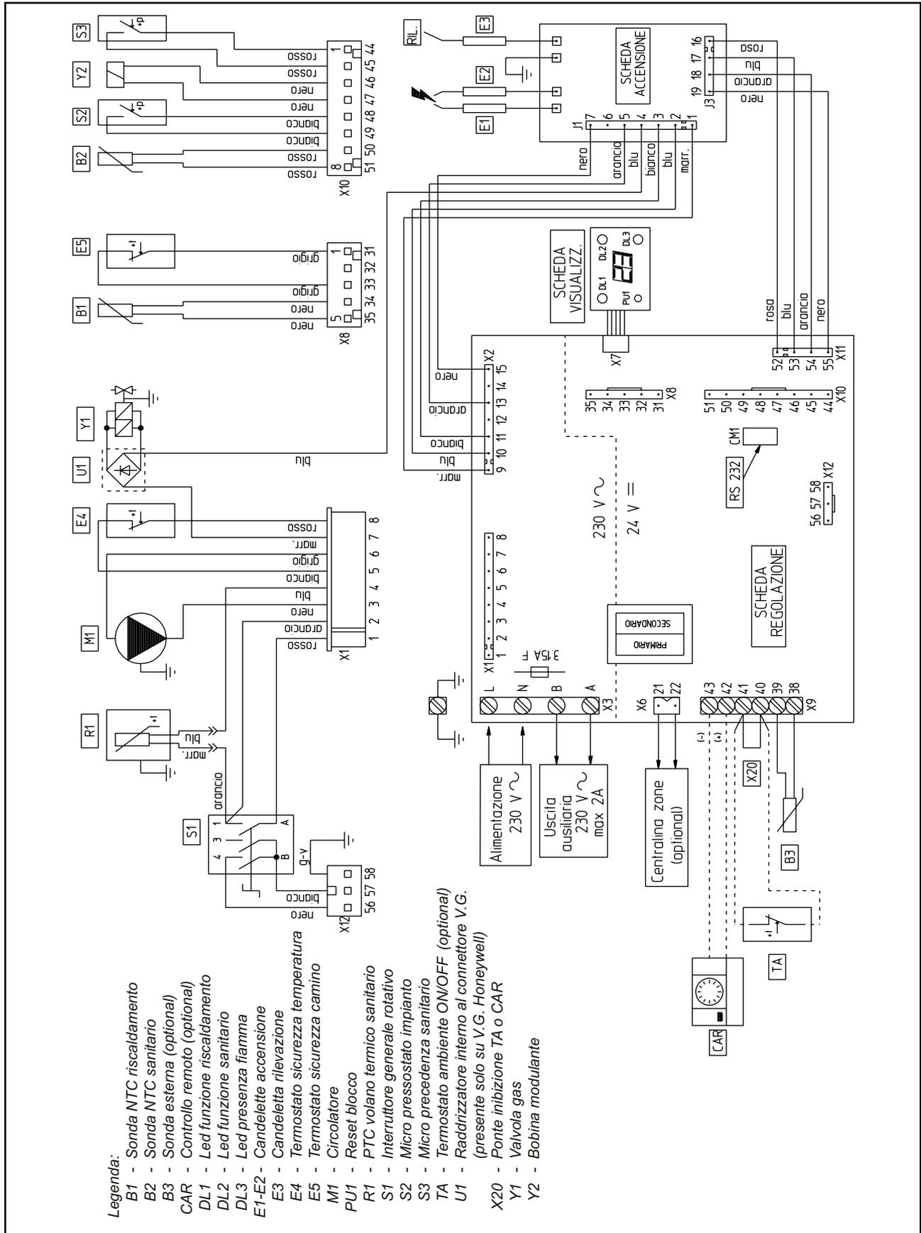
Termostato Ambiente o Comando Amico Remoto: la caldaia è già predisposta per l'applicazione del Termostato Ambiente (TA) o del Comando Amico Remoto (C.A.R.). Collegare il Termostato Ambiente sui morsetti 40
