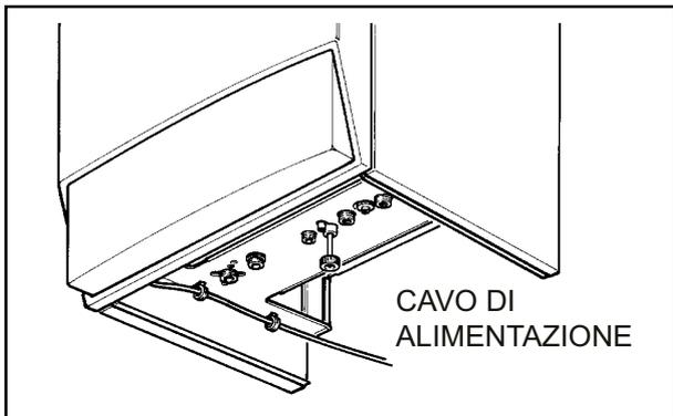
In caso si debba sostituire il fusibile di rete sulla scheda di regolazione, usare un fusibile di 3,15A rapido. Per l'alimentazione generale dell'apparecchio dalla rete elettrica, non è consentito l'uso di adattatori, prese multiple e prolunghie.
