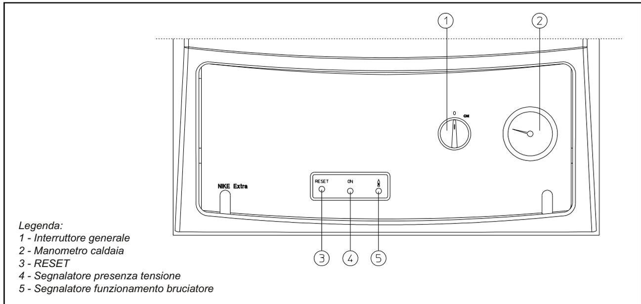
**Accensione della caldaia.** Prima dell'accensione verificare che l'impianto sia pieno d'acqua controllando che la lancetta del manometro (2) indichi una pressione di 1÷1,2 bar, il Comando Amico Remoto sia collegato ed il suo selettore sia posto in posizione Estate o Inverno.
