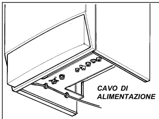
mm. In caso di sostituzione del cavo di alimentazione rivolgersi al Centro Assistenza Tecnica Autorizzato Immergas. Il cavo di alimentazione deve rispettare il percorso prescritto come da figura sopra.
