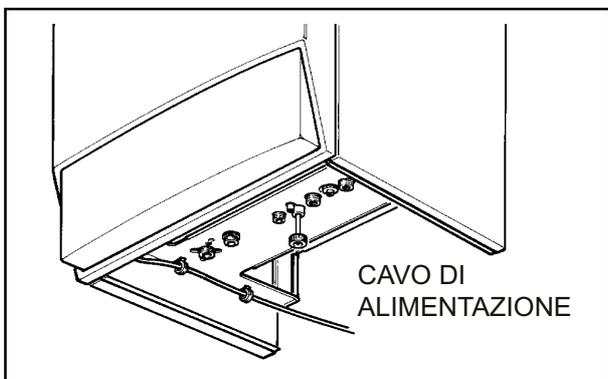
In caso si debba sostituire il fusibile di rete sulla scheda di regolazione, usare un fusibile di 3,15A rapido. Per l'alimentazione generale dell'apparecchio dalla rete elettrica, non è consentito l'uso di adattatori, prese multiple e prolunghie.
