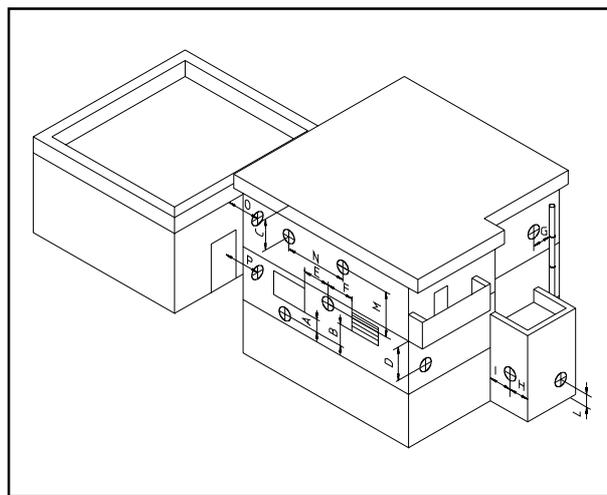
**Scarico dei prodotti della combustione di apparecchi a tiraggio naturale entro spazi chiusi a cielo libero.** Negli spazi a cielo libero chiusi su tutti i lati (pozzi di ventilazione, cavedi, cortili e simili), è consentito lo scarico diretto dei prodotti della combustione di apparecchi a gas a tiraggio naturale o forzato e portata termica oltre 4 e fino a 35 kW, purchè vengano rispettate le condizioni di cui alla normativa tecnica vigente (UNI 7129:2001 par. 5.7).
