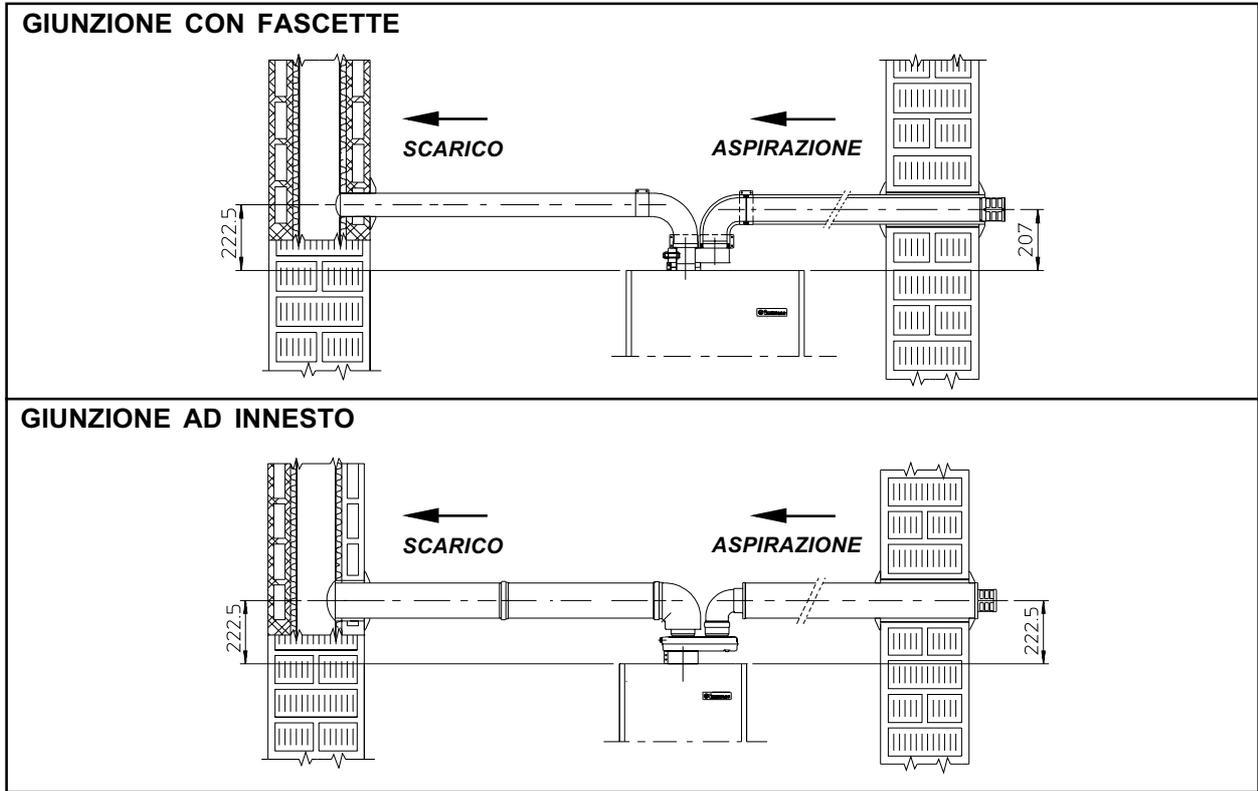
**N.B.:** Il gomito coibentato ha l'asse di uscita con una sporgenza dalla caldaia inferiore rispetto al gomito non coibentato (solo per giunzione con fascette) (vedi figura).
