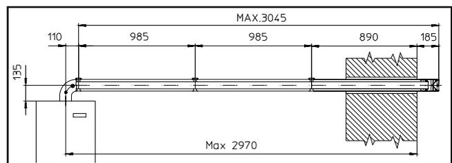
Collegamento con N°1 prolunga. MAX distanza fra asse verticale caldaia e parete esterna mm 1985.
