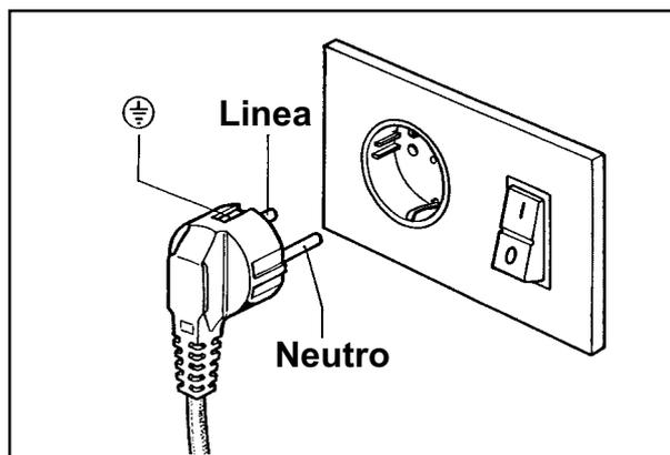
L'allacciamento deve essere effettuato interponendo fra la rete e la caldaia un interruttore onnipolare con distanza fra i contatti di apertura di almeno 3 mm.
