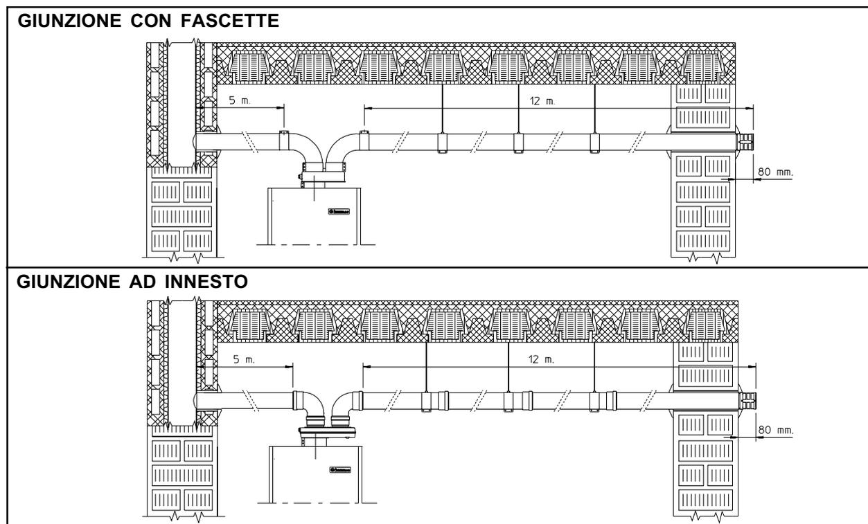
**N.B.: Durante l'installazione dei condotti Ø 80 è necessario installare ogni 3 metri una fascetta rompitratta con tassello.**
