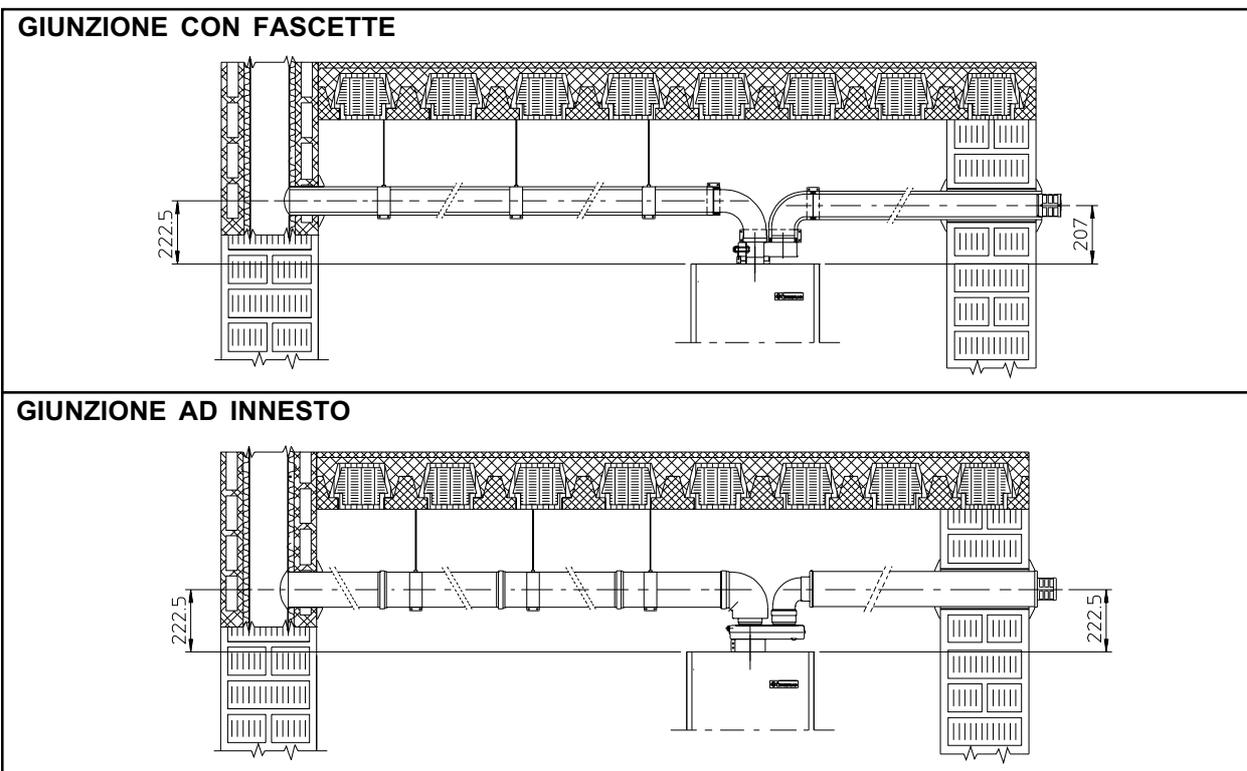
Nella figura sopra è rappresentato un caso tipico di coibentazione, la condotta di aspirazione breve e la condotta di scarico molto lunga (superiore a 5 m).
