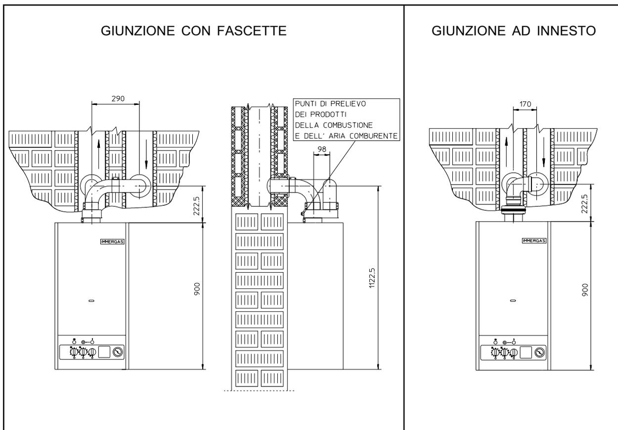
N.B.: Nel caso che i punti di prelievo dei prodotti della combustione e dell'aria comburente non fossero accessibili per l'eventuale disposizione particolare del separatore a ciabatta (vedi figura), l'IMMERMERGAS fornisce a richiesta i gomiti con i pozzetti necessari per le analisi dei fumi e la misura della temperatura dell'aria comburente secondo le norme vigenti.
