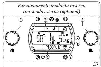
Da questo momento la caldaia funziona automaticamente. In assenza di richieste di calore (riscaldamento o produzione acqua calda sanitaria), la caldaia si porta in funzione "attesa" equivalente a caldaia alimentata senza presenza di fiamma.
