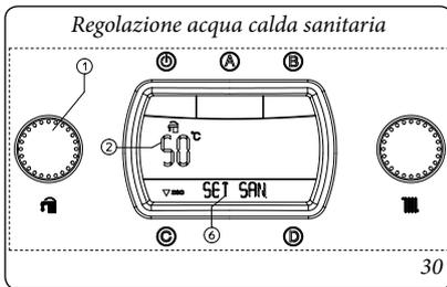
Durante il riscaldamento dell'acqua calda sanitaria compare sul display (24) la scritta "SANITAR." sull'indicatore di stato (6) e contemporaneamente all'accensione del bruciatore si accende l'indicatore (8) di presenza fiamma con relativa scala di potenza e l'indicatore (9 e 7) con la temperatura istantanea in uscita dallo scambiatore primario.
