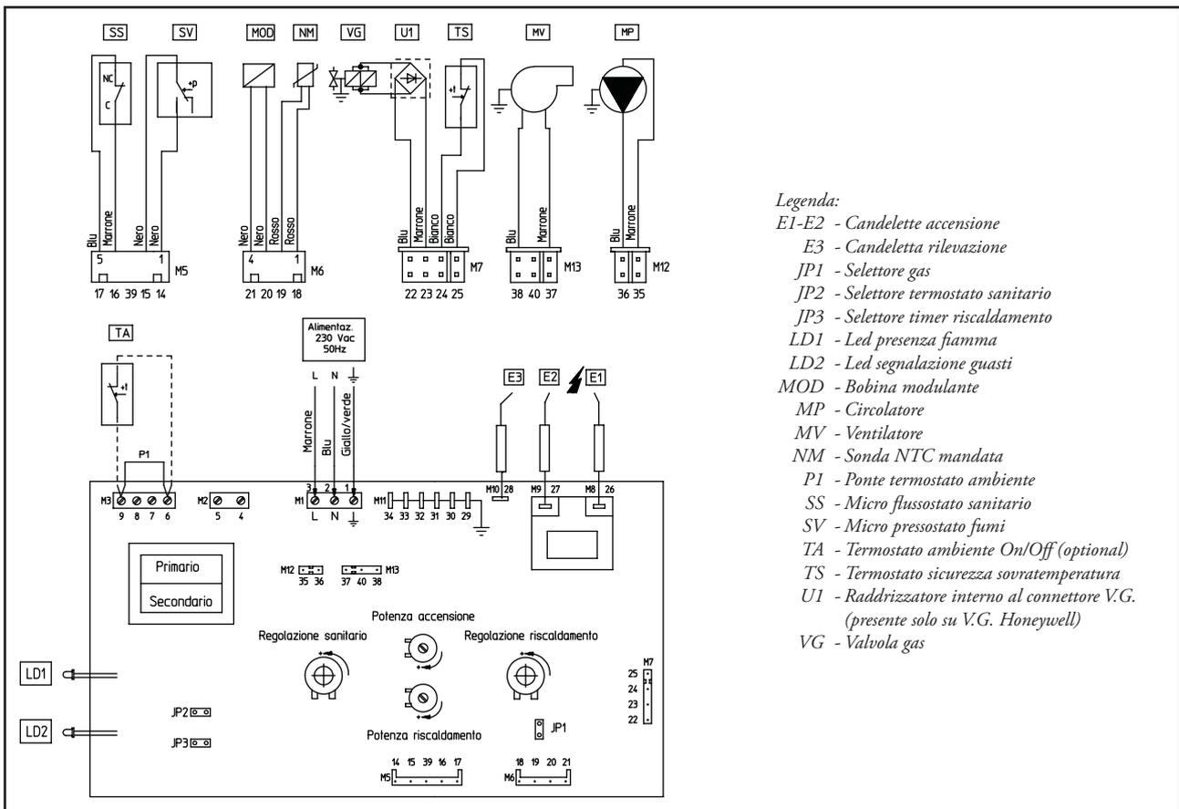
Termostato ambiente: la caldaia è predisposta per l'applicazione del Termostato Ambiente (TA). Collegare sui morsetti 6 e 9 eliminando il ponte P1.
