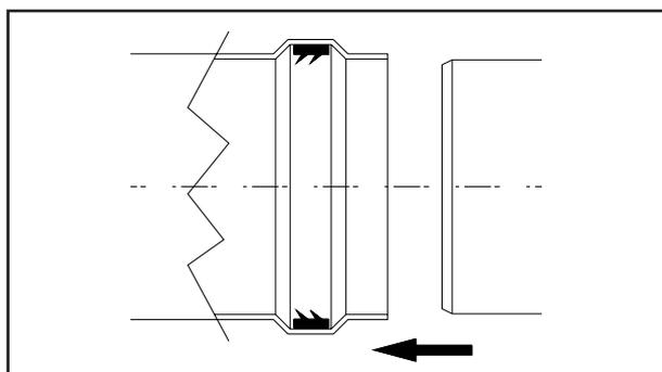
**Installazione diaframma.** Per un corretto funzionamento della caldaia è necessario installare sull'uscita della camera stagna e prima del condotto di aspirazione e scarico un diaframma (vedi figura). La scelta del diaframma appropriato avviene in base al tipo di condotto e alla sua massima estensione: detto calcolo si può effettuare con l'utilizzo delle seguenti tabelle:
