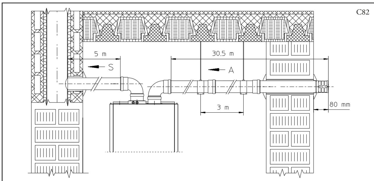
**N.B.:** durante l'installazione dei condotti Ø 80 è necessario installare ogni 3 metri una fascetta rompitratta con tassello.
