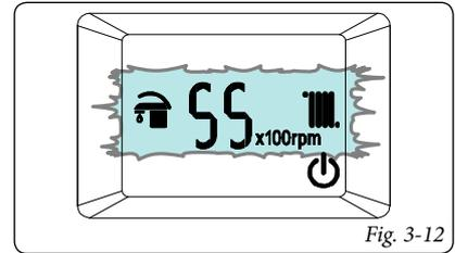
L'apparecchio resta in questa modalità per un tempo massimo di 15 minuti mantenendo costante la velocità del ventilatore.
