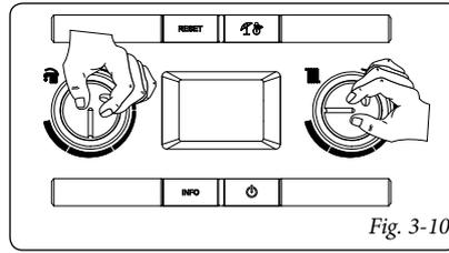
Attivata la funzione la caldaia effettua in sequenza le operazioni necessarie per tarare l'apparecchio alla potenza nominale, intermedia e minima.
