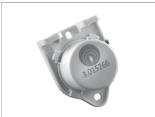
La sonda esterna consente di diminuire o aumentare automaticamente la temperatura massima di mandata all'impianto all'aumentare o diminuire della temperatura esterna in modo da adeguare il calore fornito all'impianto in funzione della variazione della temperatura esterna.
