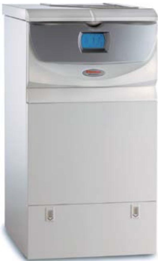
ARES CONDENSING 32 ErP è la caldaia a basamento a camera stagna a condensazione per solo riscaldamento, con potenza termica nominale di 32,0 kW (27.520 kcal/h) che si caratterizza per la compattezza dimensionale e per il peso contenuto. E' omologata per installazione solo all'interno dell'edificio.
