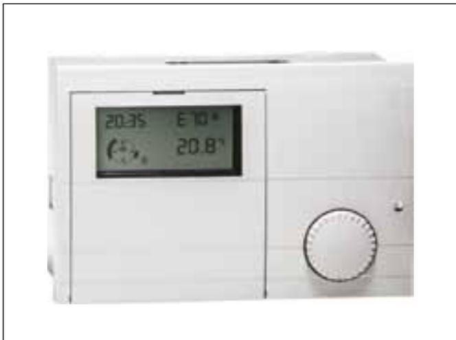
Consente di gestire 2 zone dirette/miscelate fino ad un massimo di 7 espansioni collegabili tramite 4 cavi mediante connessione CANBUS (L/H/+/-) con lunghezza massima di 250 metri.
