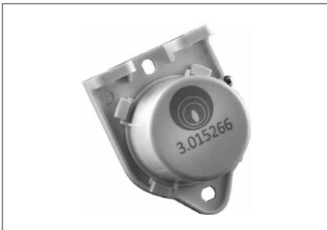
La sonda esterna consente di diminuire o aumentare automaticamente la temperatura massima di mandata all'impianto all'aumentare o diminuire della temperatura esterna in modo da adeguare il calore fornito all'impianto in funzione della variazione della temperatura esterna.
