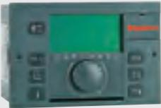
Regola accensione, spegnimento, modulazione ed anomalie dei moduli in cascata (max 8), gestisce i regolatori climatici delle zone (max 3 più 1 dedicata al circuito di acqua calda sanitaria) in cui è suddiviso un impianto (sia nel caso di installazione singola che in cascata). <b>Gestisce inoltre un impianto solare</b> che è costituito da: sonda collettore, sonda Unità Bollitore e gruppo di circolazione solare | 3.015244 |
