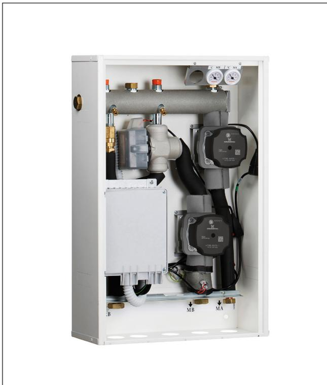
Il kit 2 zone per abbinamento a MAGIS COMBO V2 è composto dal telaio, dal collettore idraulico aperto, da elettropompe a basso consumo elettrico, valvola tre vie miscelatrice, tubi e raccordi idraulici e termometri per la lettura delle temperature. I circolatori inseriti nel kit, hanno la particolarità di essere molto elastici anche grazie alle modalità di funzionamento che possono essere pre-impostate.
