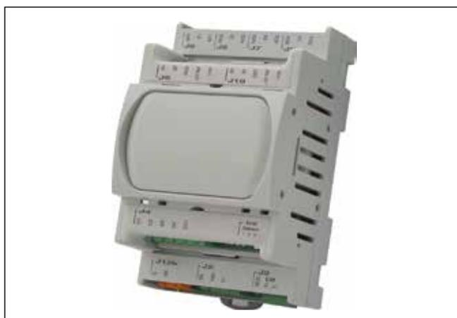
È un componente che deve essere alimentato a 24 Vac e serve principalmente per la gestione delle zone dell'impianto; in particolare occorre utilizzare n°1 kit espansione per ciascuna zona. Il kit espansione gestisce pompa, valvola miscelatrice e il deumidificatore della zona medesima acquisendo la richiesta ambiente (temperatura e umidità) per una determinata zona. A questo kit è possibile collegare:
