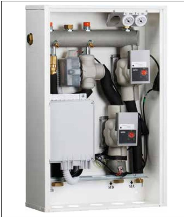
Il kit 2 zone per abbinamento a MAGIS COMBO V2 è composto dal telaio, dal collettore idraulico aperto, da elettropompe a basso consumo elettrico, valvola tre vie miscelatrice, tubi e raccordi idraulici e termometri per la lettura delle temperature. I circolatori inseriti nel kit, hanno la particolarità di essere molto elastici anche grazie alle 7 curve di funzionamento che possono essere pre-impostate.
