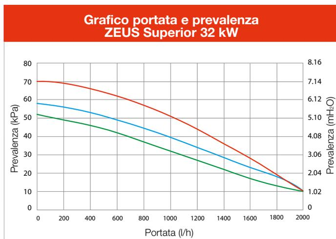
La caldaia ZEUS Superior kW è completa di **by-pass regolabile**.
