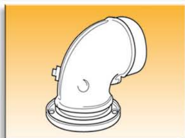
Kit curva flangiata 90° concentrica Ø 60/100 con prese ispezione fumi Cod. 08515150
