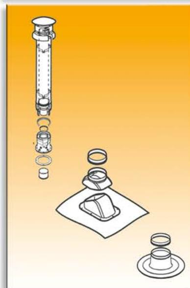
**Kit scarico a tetto concentrico Ø 125**
