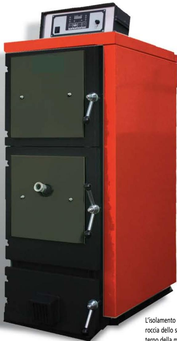
MASAJA BJO è una caldaia in acciaio a tre giri di fumo, ad alto rendimento. La gamma è costituita da quattro modelli per solo riscaldamento con potenze termiche al focolare di 21, 31, 49 e 62 kW tutte disponibili in versione con accensione del pellet automatico o manuale
