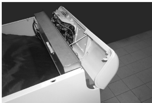
Fig. 6 - Far ruotare in avanti il pannello comandi.
