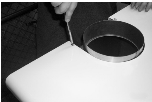
Fig. 3 - Svitare le 2 viti autofilettate che tengono il coperchio della caldaia.
