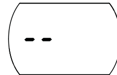
fig. 2 - Apagado de la caldera
