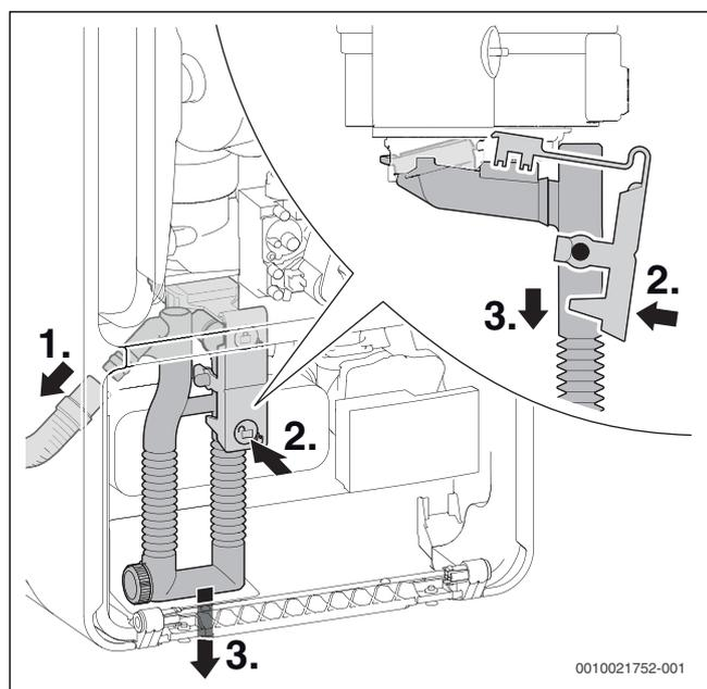
Fig. 49 Smontaggio del sifone per la condensa
