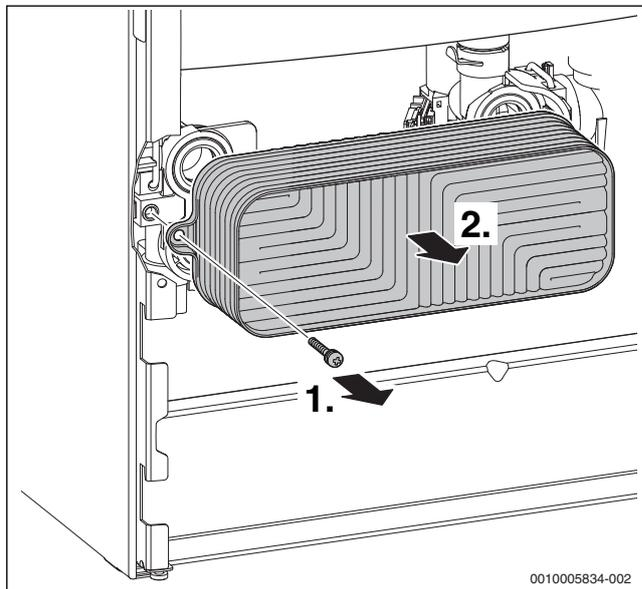
Fig. 57 Smontaggio dello scambiatore di calore a piastre
