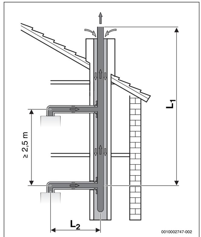
Fig. 18 Occupazione multipla con condotto concentrico secondo  $C_{43}$
