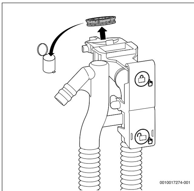
Fig. 51 Rimozione della guarnizione posta sul lato superiore del sifone per la condensa
