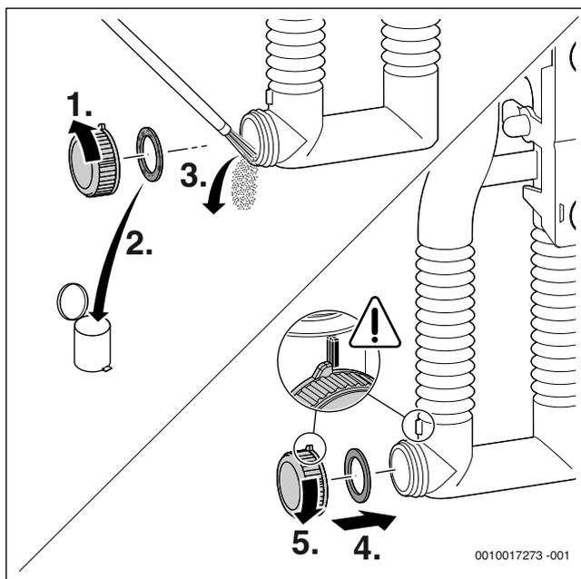
Fig. 50 Pulizia del sifone per la condensa
