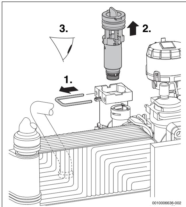
Fig. 56 Controllo del filtro nel tubo acqua fredda
