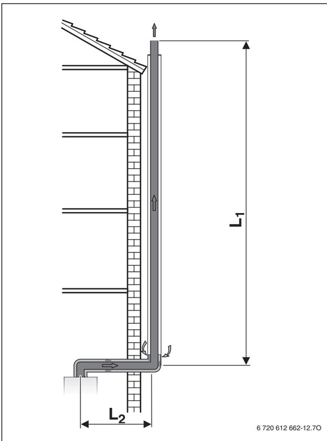
Fig. 16 Passaggio gas combustibili sulla facciata secondo C<sub>53</sub>
