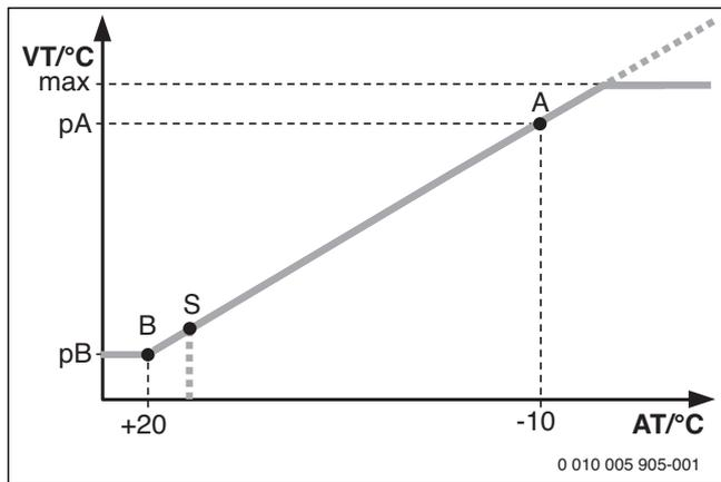
Fig. 70 Curva termocaratteristica
