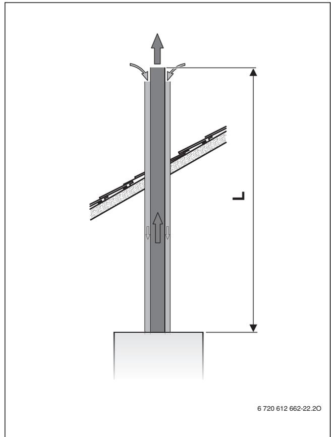
Fig. 14 Passaggio gas combustivi verticale secondo C<sub>33</sub>
