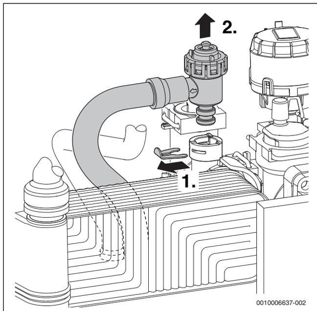
Fig. 55 Rimozione della valvola di sicurezza (circuito di riscaldamento)
