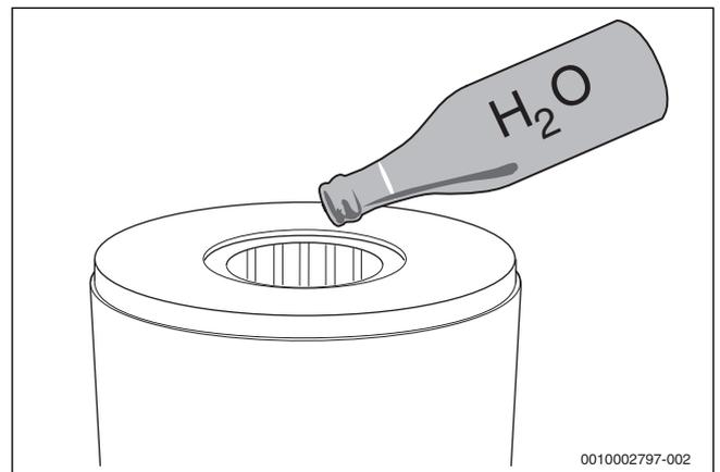
Fig. 48 Lavaggio con acqua dello scambiatore primario
