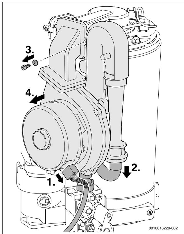
Fig. 40 Smontaggio del ventilatore con dispositivo di miscelazione
