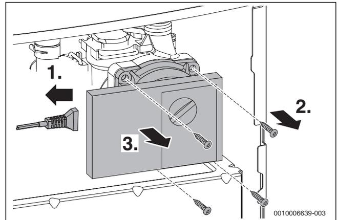
Fig. 60 Smontaggio del circolatore di riscaldamento
