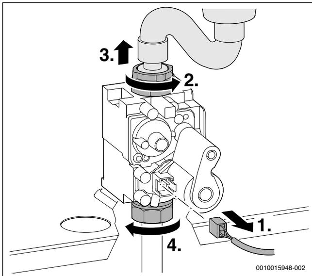
Fig. 58 Estrarre il connettore e allentare i dadi di raccordo
