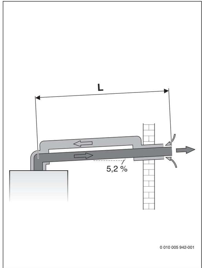
Fig. 13 Passaggio gas combustivi orizzontale secondo C<sub>13</sub>
