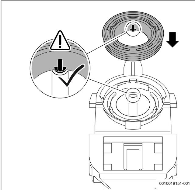
Fig. 52 Allineamento della nuova guarnizione sul sifone per la condensa
