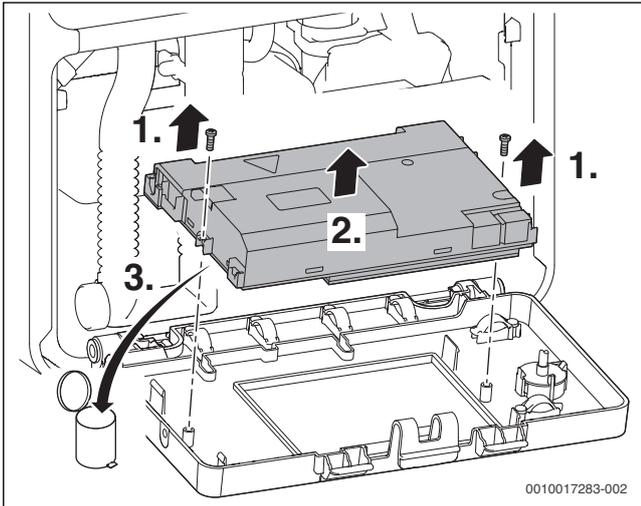
Fig. 65 Sostituzione dell'elettronica dell'apparecchio
