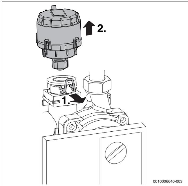
Fig. 62 Smontaggio del motore della valvola a 3 vie
