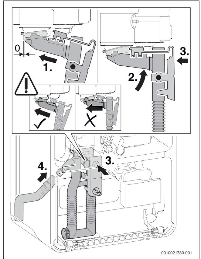
Fig. 54 Applicazione del sifone per la condensa
