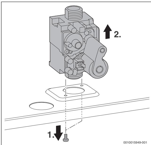
Fig. 59 Smontaggio della valvola del gas
