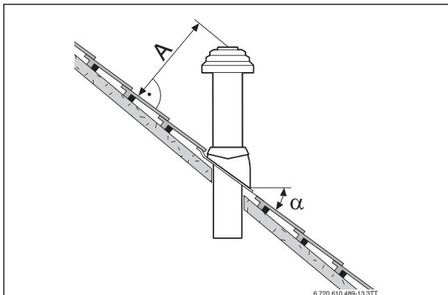
Fig. 6 Distanze ed inclinazione con tetto inclinato
