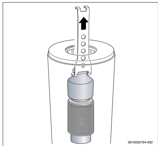
Fig. 44 Estrazione del deviatore di fiamma superiore
