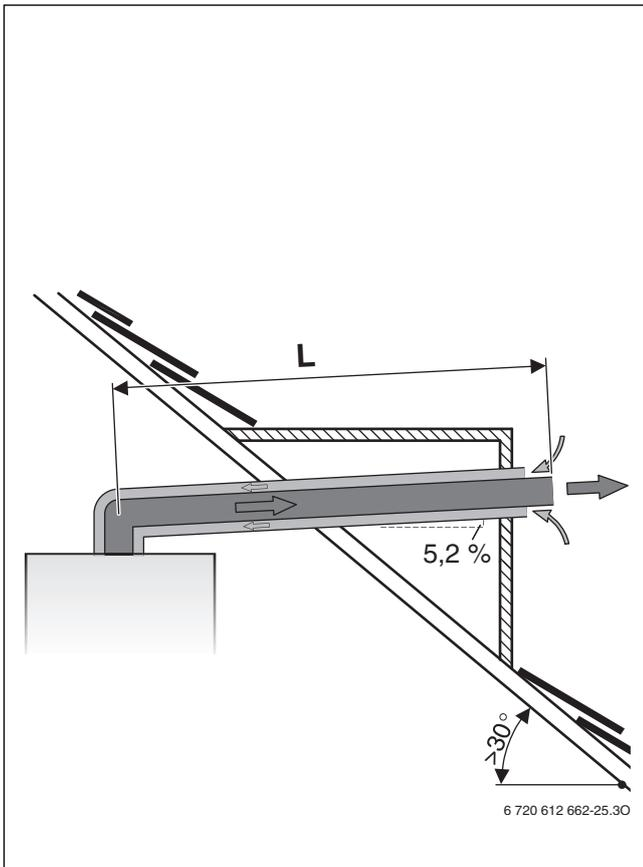
Fig. 12 Passaggio gas combustivi orizzontale secondo C<sub>13</sub>
