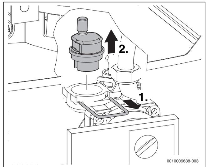
Fig. 61 Smontaggio del disaeratore automatico
