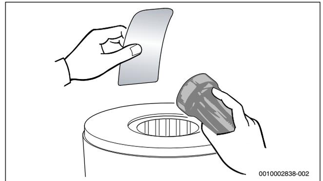
Fig. 47 Controllo della presenza di residui nello scambiatore primario
