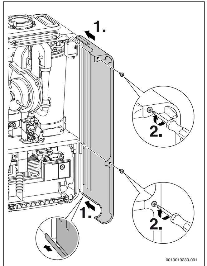
Fig. 67 Applicazione del rivestimento laterale
