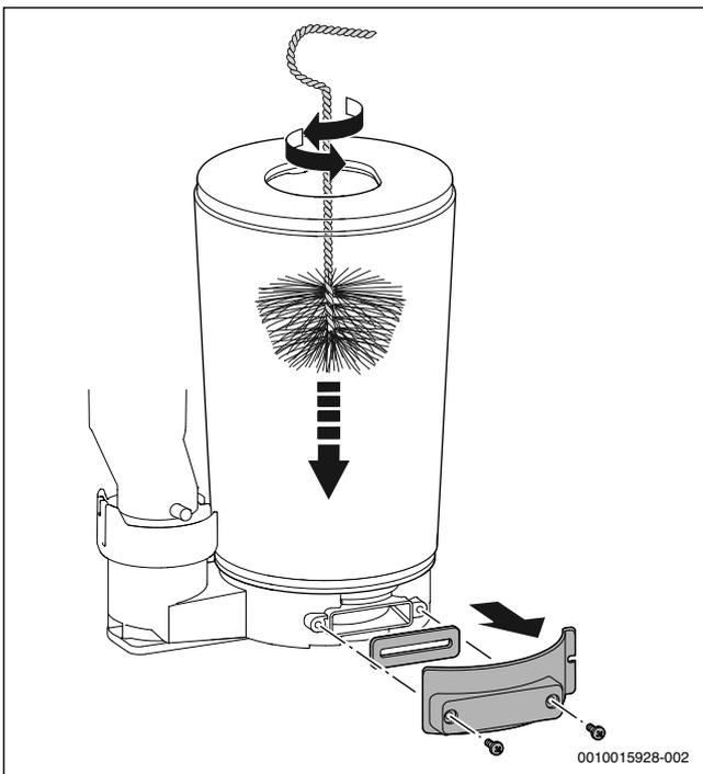
Fig. 46 Pulizia dello scambiatore primario
