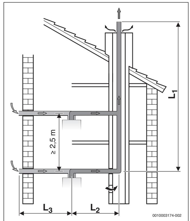
Fig. 19 Occupazione multipla con condotto aspirazione/scarico secondo  $C_{83}$
