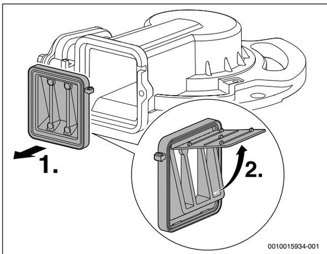
Fig. 42 Valvola di ritegno a clapet nel dispositivo di miscelazione
