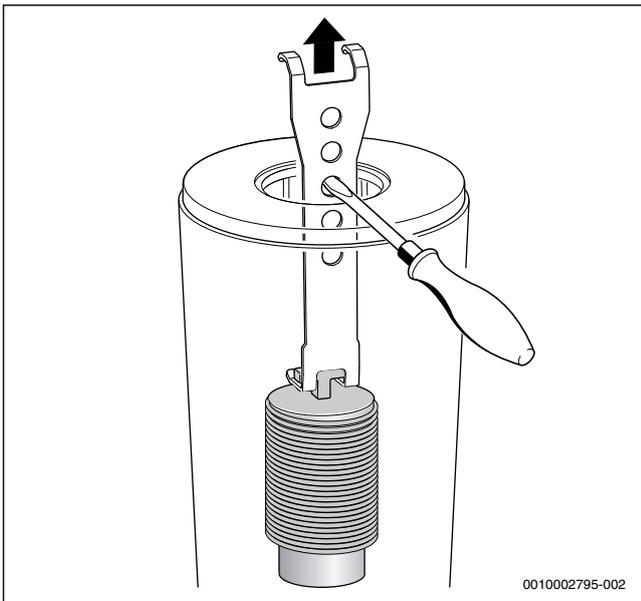
Fig. 45 Estrazione del deviatore di fiamma inferiore
