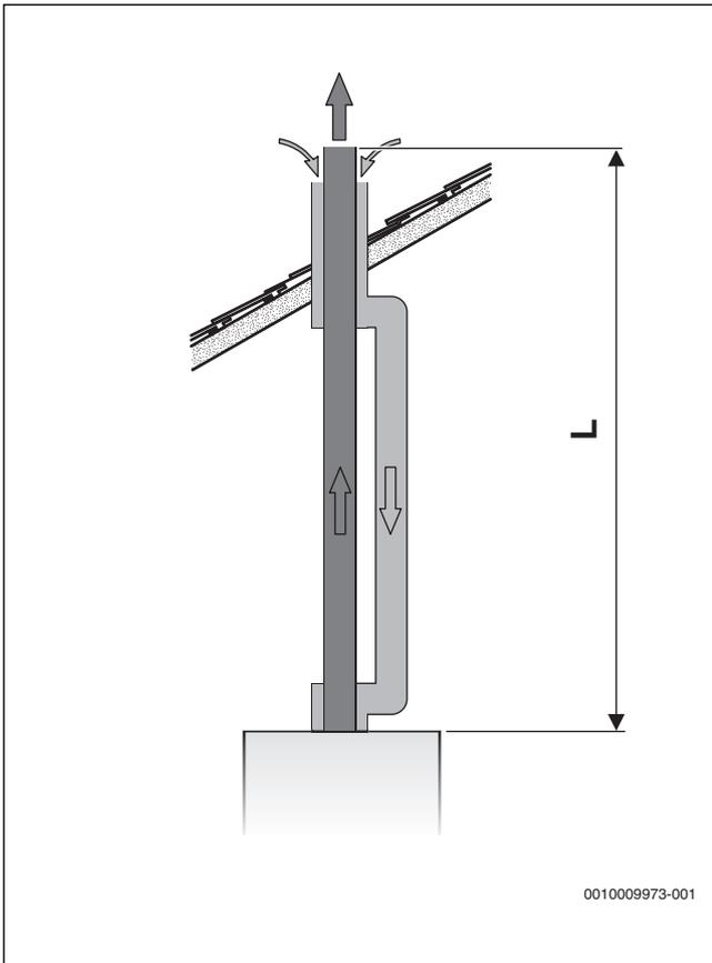
Fig. 15 Passaggio gas combustibili verticale secondo C<sub>33</sub>
