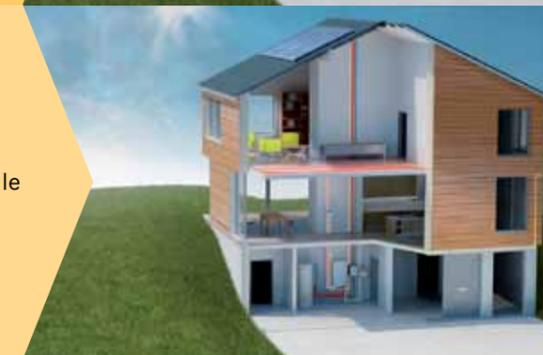
**3.** Se l'energia solare risulta sufficiente, in automatico la termoregolazione abbassa la curva di riscaldamento, calcolando una temperatura necessaria inferiore, ad esempio 35 °C, riducendola di 5 °C; in questo modo il comfort ambientale rimane stabile a circa 20 °C. Grazie al sistema brevettato SolarInside-ControlUnit, l'ottimizzazione dell'energia solare permette un ulteriore risparmio di gas.
