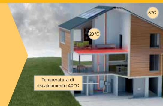
**2.** Appena i primi raggi solari scaldano i collettori, la termoregolazione con funzione SolarInside-ControlUnit registra l'energia solare disponibile e tramite un algoritmo calcola la probabilità che l'energia solare che entra dalle finestre del lato sud sia sufficiente a scaldare la stanza.
