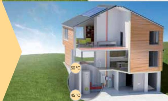
**3.** Tutto ciò significa che se ci sarà richiesta di acqua calda sanitaria per il bagno o la doccia, la caldaia non entrerà in funzione per ripristinare la temperatura di 60 °C nel bollitore, avendo calcolato una temperatura di comfort inferiore, uguale a 45 °C. Questo permette il massimo sfruttamento dell'energia solare sufficiente a mantenere il bollitore ad una temperatura di comfort, riducendo i consumi di gas.
