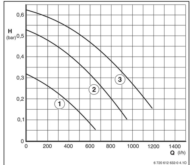
Fig. 34 Diagramma delle curve caratteristiche/velocità del circolatore
