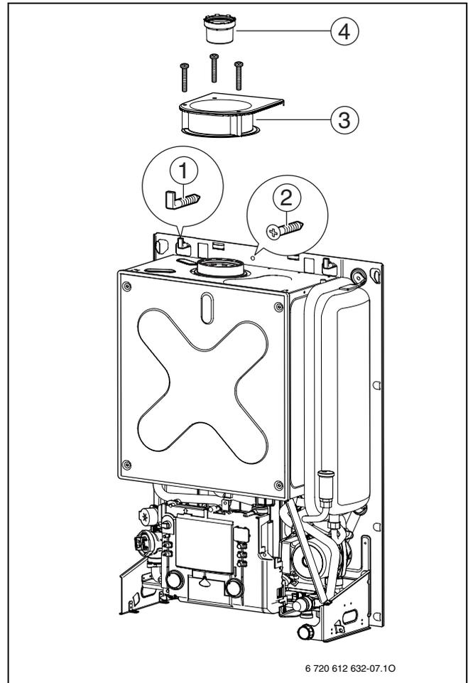
Fig. 11 Fissaggio a parete
