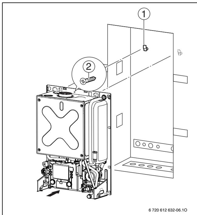
Fig. 12 Fissaggio a parete nel guscio ad incasso
