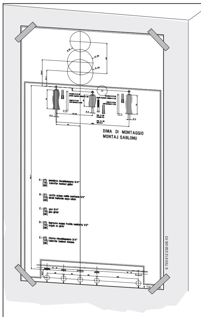
Fig. 9 Fissaggio a parete della sagoma di installazione
