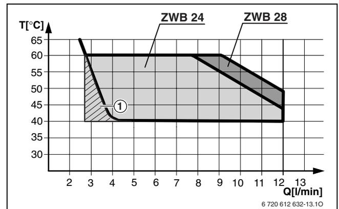
Fig. 35 Diagramma per una temperatura di ingresso dell'acqua fredda di +15°C
