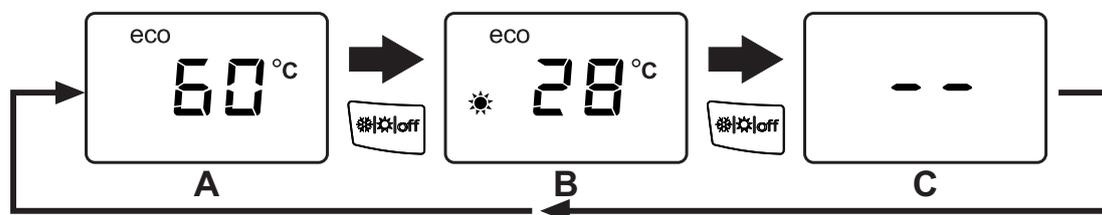
fig. 8 - Spegnimento caldaia
