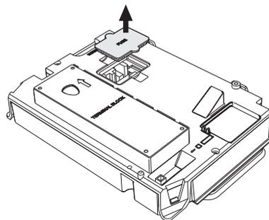
fig. 33 - Alloggiamento fusibile
