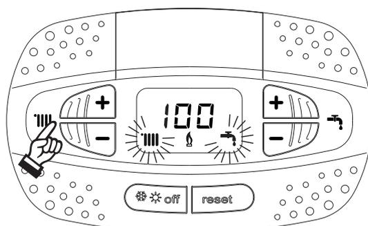
fig. 31 - Modalità TEST (potenza riscaldamento = 100%)
