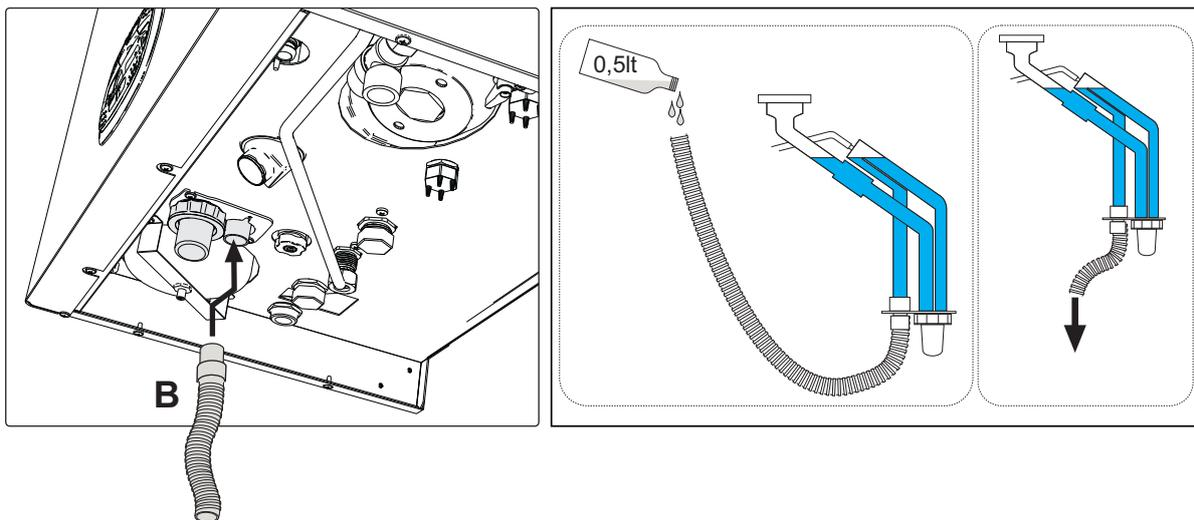
fig. 29 - Collegamento scarico condensa
