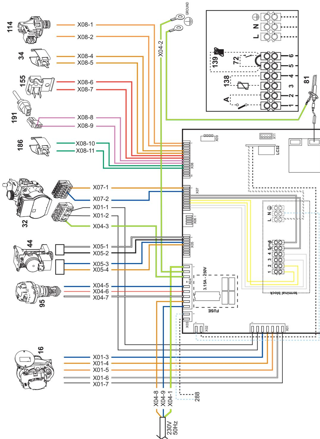
fig. 42 - Schema elettrico
