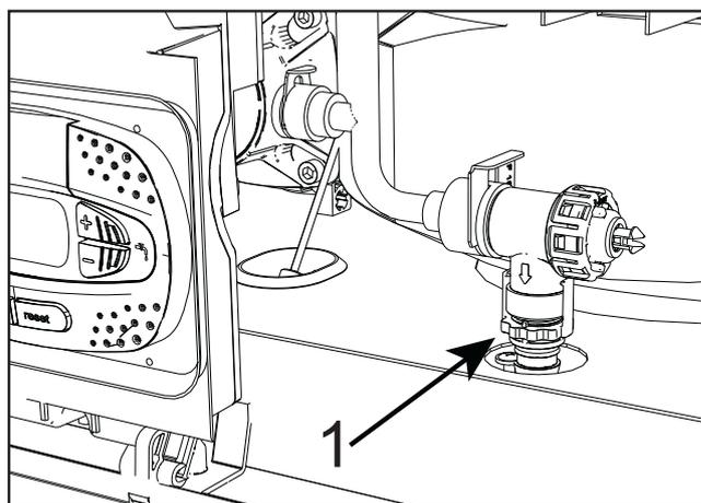
fig. 17 - Valvola di sicurezza con rubinetto di scarico
