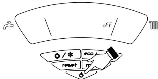
fig. 6 - Spegnimento caldaia
