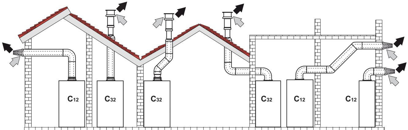
fig. 20 - Esempi di collegamento con tubi coassiali ( = / → = Fu →
