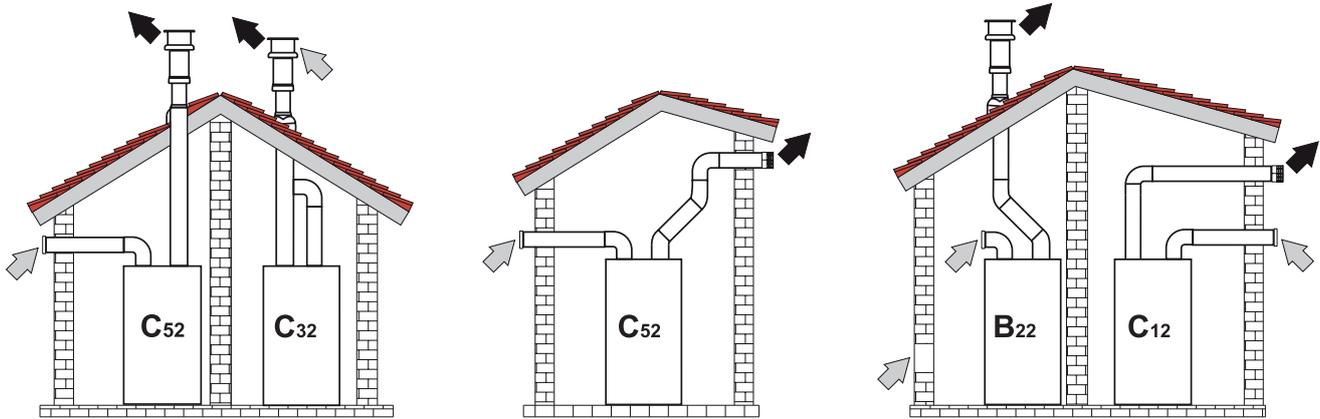
fig. 22 - Esempi di collegamento con tubi separati ( = ➡ = Fi ➡)
