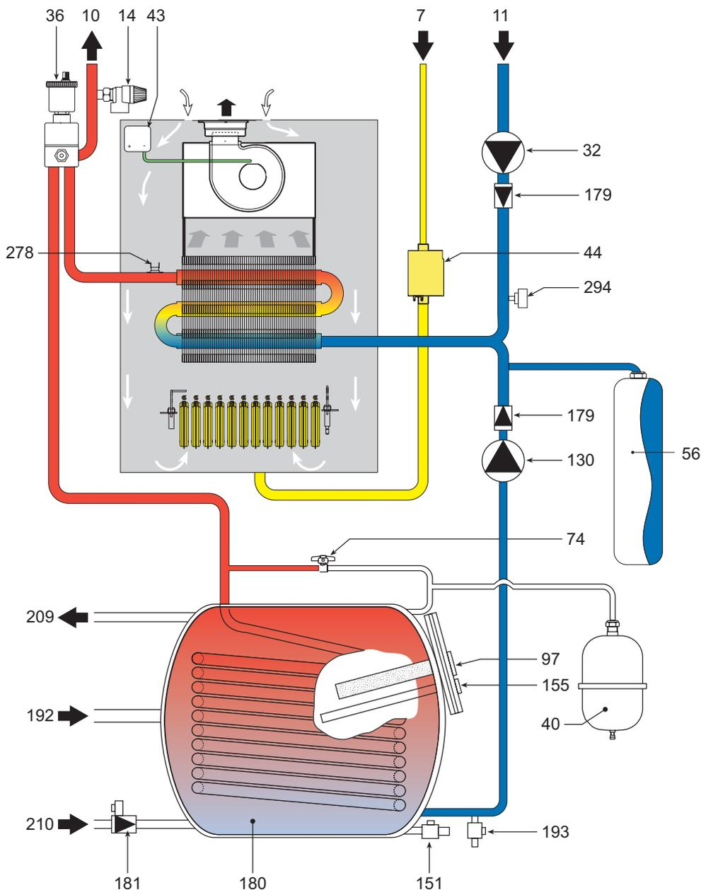
fig. 31 - Circuito idraulico
