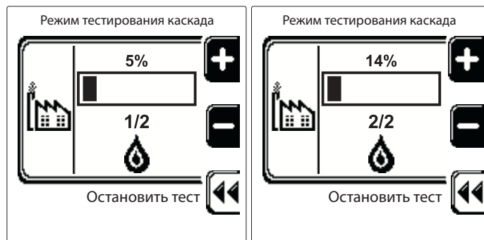
рис. 66 - Тестовый режим каскадной схемы (пример с двумя модулями)
