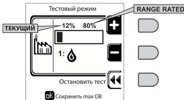
рис. 64 - Тестовый режим TEST (пример: мощность отопления = 80%)
